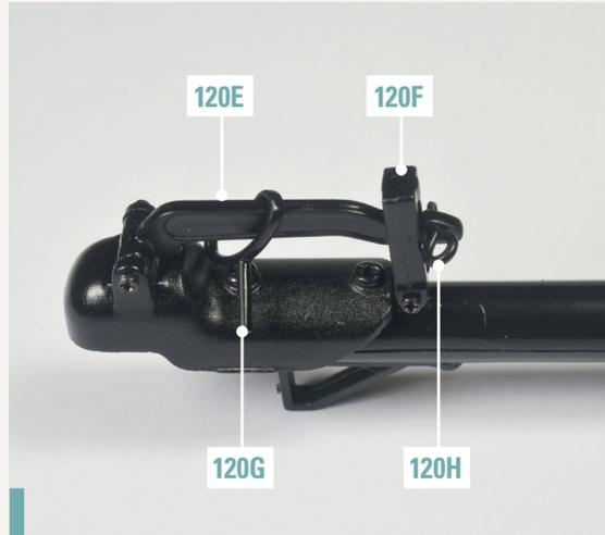
**121-2.** Stecken Sie das Ende des Hebels 120E in den Bügelbolzen 120F und den kleinen Bolzen 120H wieder in das Loch des Hebels. Dadurch wird verhindert, dass sich die Baugruppe öffnet und der große Bolzen 120G verloren geht.
