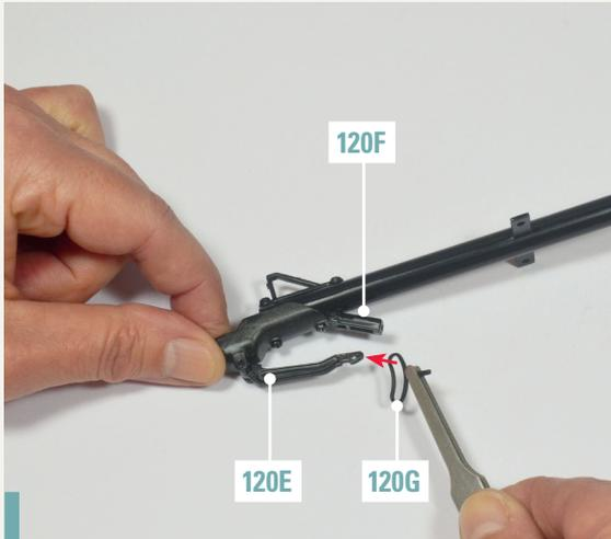
**121-1.** Nehmen Sie die Deichsel und den großen Bolzen 120G zur Hand. Um diesen nicht zu verlieren, können Sie ihn auf den Hebel 120E stecken (nachdem Sie den kleinen Bolzen entfernt und den Hebel aus dem Bügelbolzen 120F genommen haben).
