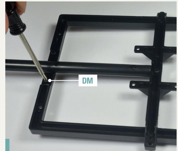
**121-6.** Beenden Sie die Befestigung der Teile, indem Sie eine Schraube DM in dem verbleibenden Loch der Deichsel anziehen.
