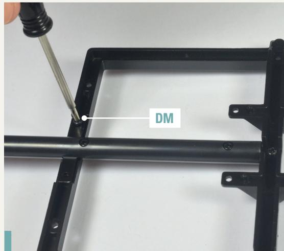
**121-5.** Fahren Sie mit der Befestigung der Teile fort, indem Sie eine Schraube DM in einem der beiden mittleren Löcher der Deichsel anziehen.
