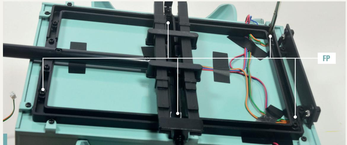
**122-10.** Schließen Sie die Befestigung des Rahmens am Anhänger ab, indem Sie fünf Schrauben FP in den gezeigten Löchern festziehen.
