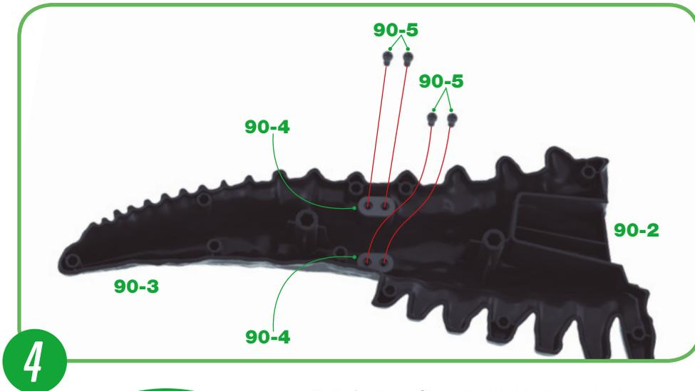
**4** Befestigen Sie jedes Verbindungsstück **90-4** mit zwei Schrauben **90-5**. ▲
