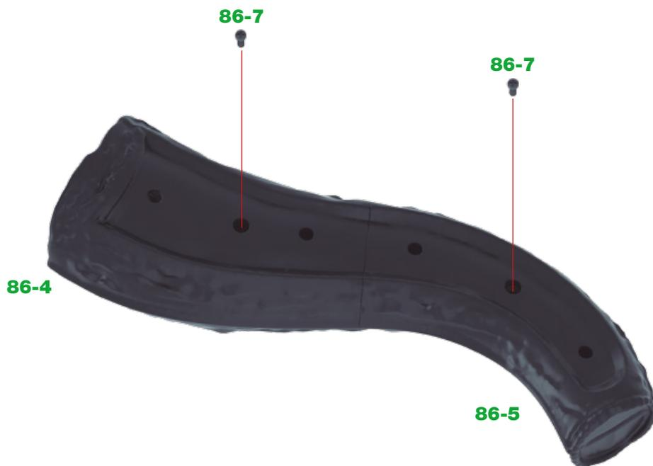
**6** Drehen Sie die Baugruppe aus Schritt 5 um und befestigen Sie die Teile mit zwei Schrauben **86-7**, die Sie in die mittleren Löcher der Teile **86-4** und **86-5** einführen, wie in der Abbildung gezeigt. ◀
