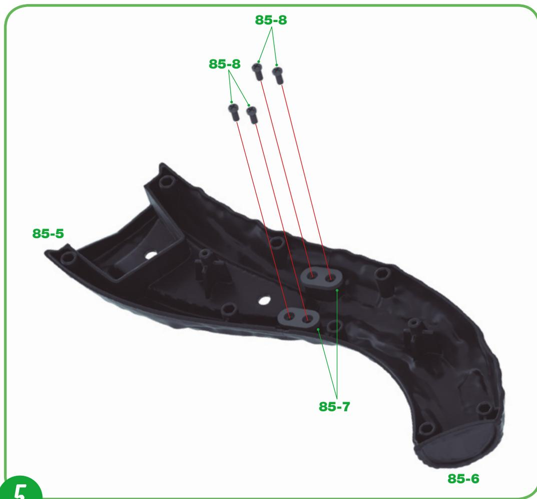
**5** Befestigen Sie die Verbindungsstücke **85-7** mit vier Schrauben **85-8**. ◀
