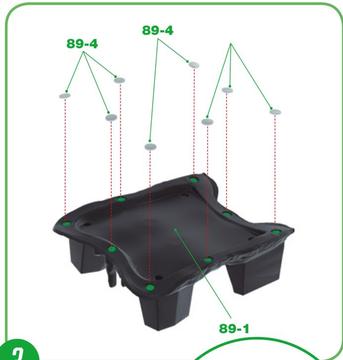
**3** Führen Sie acht **3** Magnete **89-4** in die kreisförmigen Vertiefungen auf der Innenseite des Batteriegehäuses **89-1** ein. Befestigen Sie sie mit einem Klebepunkt. ▲
