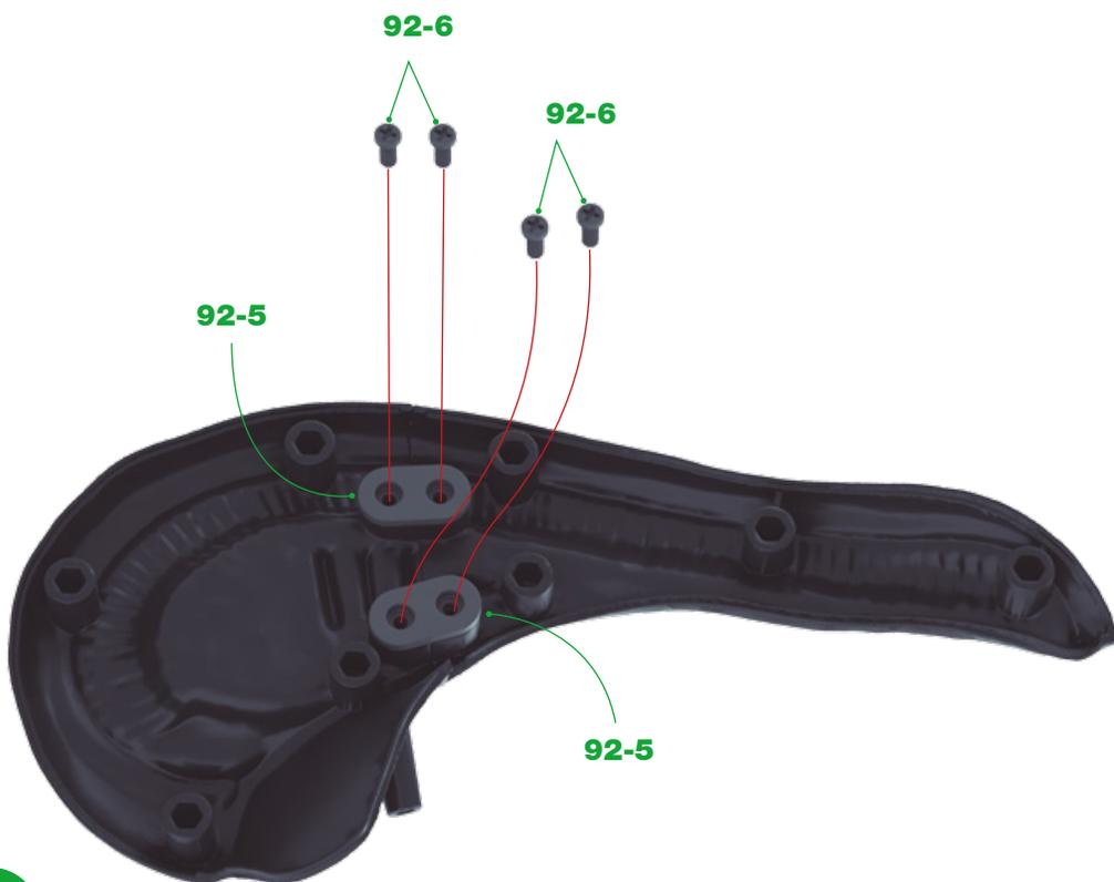
**2** Befestigen Sie jedes Verbindungsstück **92-5** mit zwei Schrauben **92-6**. ▶
