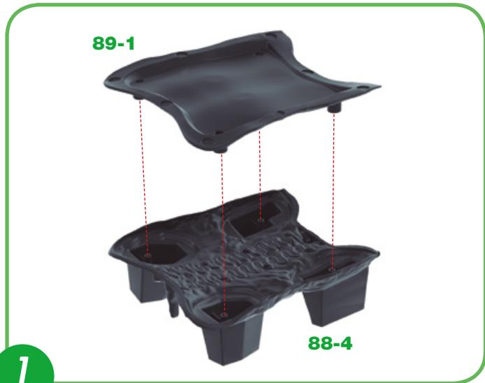
**1** Stecken Sie die vier Zapfen des Batteriegehäuses **89-1** in die vier Zapfen von Teil **88-4**, wie in der Abbildung gezeigt. ▲
