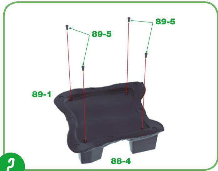
**2** Befestigen Sie die Teile von Schritt 1 mit vier **89-5** Schrauben aneinander, wie in der Abbildung gezeigt. ▲
