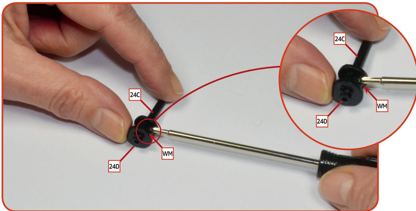
**03** Verbinden Sie die Stoßdämpferstange **24C** und die Spindelgabel **24D** und richten Sie die Teile wie gezeigt aus. Befestigen Sie sie, indem Sie eine **WM**-Schraube in dem markierten Loch anziehen.
