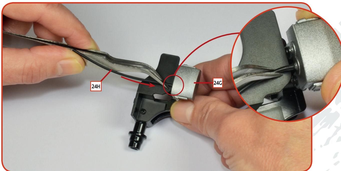
**04** Stecken Sie ein Ende des Schlauchs **23H** auf den Bolzen des Bremssattels **24G**.
