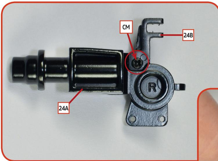
**01** Setzen Sie die Stoßdämpfergabel **24B** an der dafür vorgesehenen Stelle auf die Spindel **24A** und befestigen Sie sie mit einer **CM**-Schraube. Montieren Sie anschließend den Bremsattel **24G** und befestigen Sie ihn an der Spindel, indem Sie zwei **SM**-Schrauben in den angegebenen Löchern festziehen.
