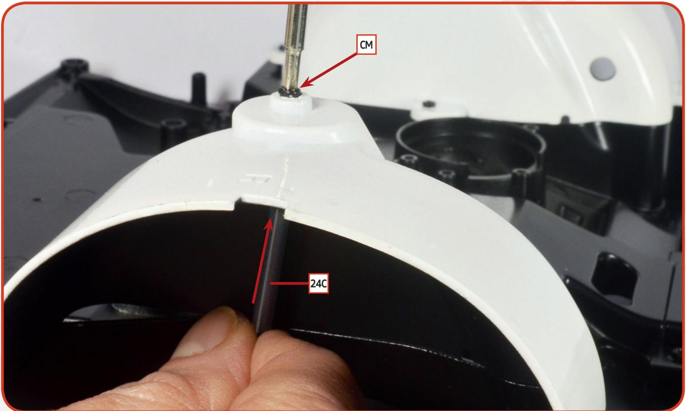
**05** Nehmen Sie die Bodenplatte Ihres Modells wieder zur Hand und montieren Sie die Stoßdämpfergabel an der vorgesehenen Stelle an der Unterseite des rechten hinteren Kotflügels. Sichern Sie sie, indem Sie eine **CM**-Schraube von der Oberseite des Kotflügels aus in das angegebene Loch eindrehen.
