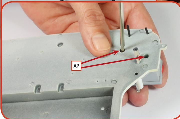
**04** Setzen Sie die Batterie an der vorgesehenen Stelle auf dem Kofferraumboden **31A** ein, stecken Sie die freien Enden der Kabel in die dafür vorgesehenen Löcher und befestigen Sie die Batterie mit zwei **AP**-Schrauben.
