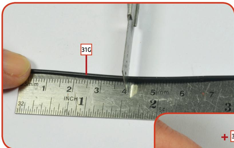
**02** Schneiden Sie das Kabel **31G** mit einem Teppichmesser in zwei Hälften und ziehen Sie die beiden erhaltenen Segmente auf die Stifte der Pole **31E** und **31F**.
