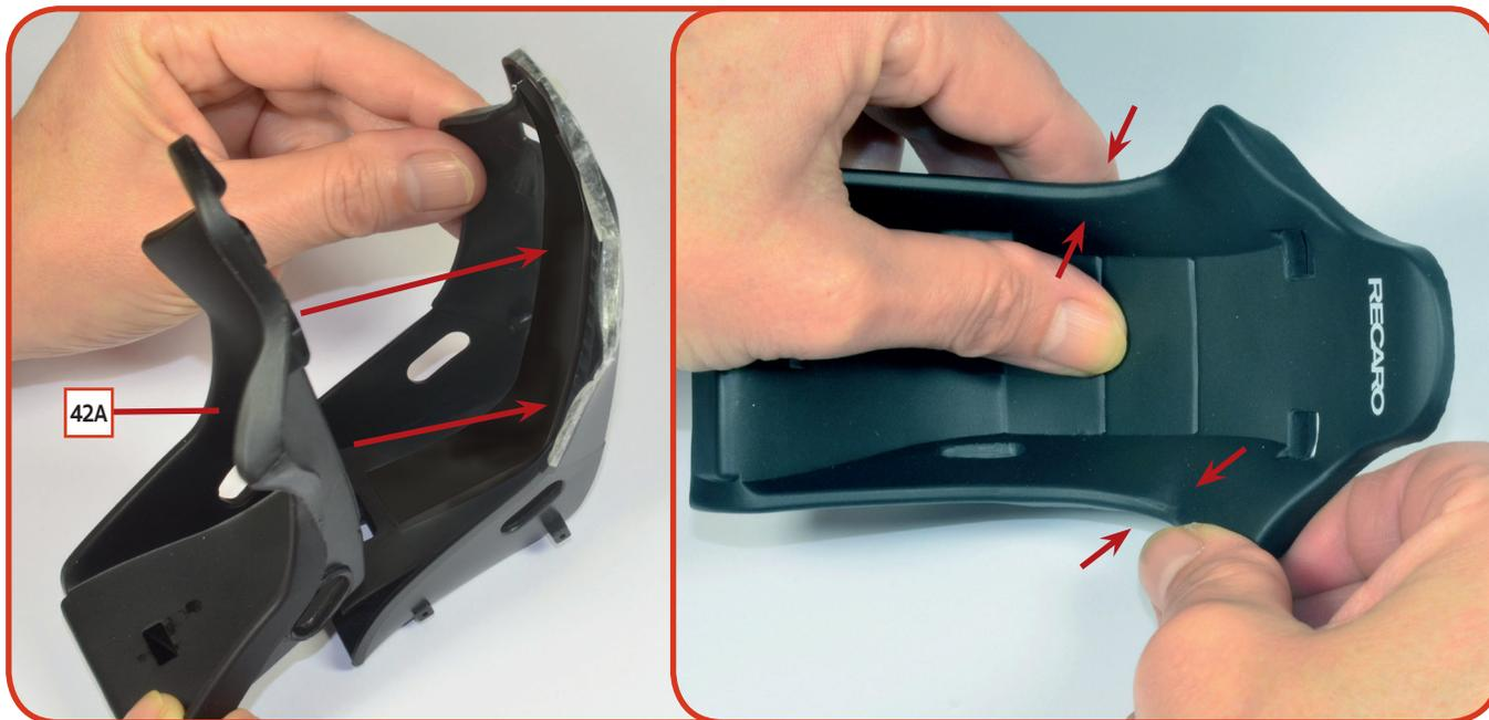
**03** Entfernen Sie die Schutzfolien von den verbleibenden Seiten aller doppelseitigen Klebestreifen und befestigen Sie den Sitz **42A** in seinem Rahmen. Üben Sie leichten Druck auf die gesamte Oberfläche des Sitzes aus, um eine optimale Haftung zu gewährleisten.
