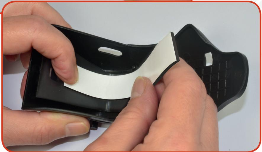
**02** Entfernen Sie die Schutzfolien von einer Seite der doppelseitigen Klebebänder **42G** und bringen Sie sie entlang der Außenkontur des Sitzrahmens an. Passen Sie sie durch Zuschneiden an die Wölbung des Rahmens an, um eine optimale Haftung zu gewährleisten.
