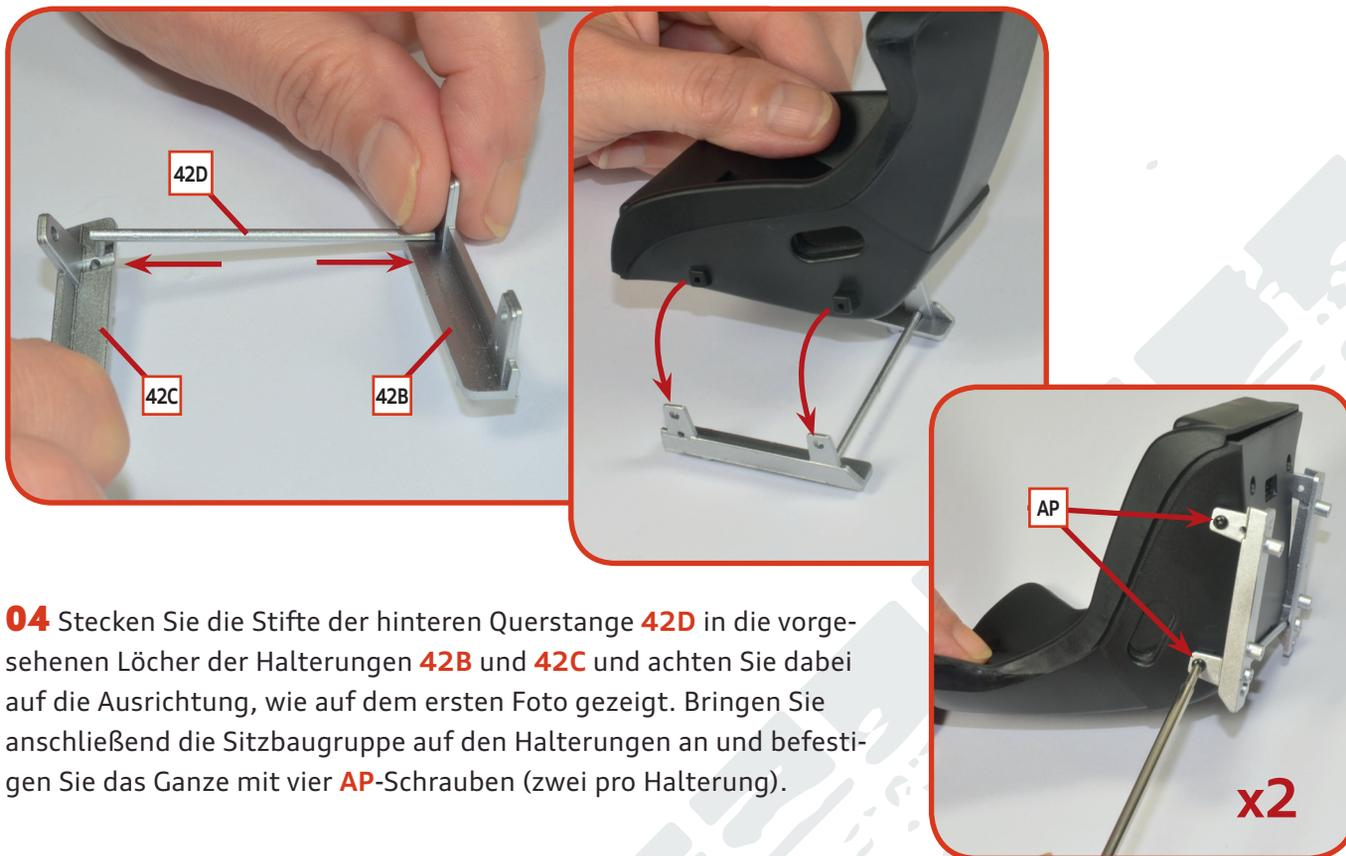
**04** Stecken Sie die Stifte der hinteren Querstange **42D** in die vorgesehenen Löcher der Halterungen **42B** und **42C** und achten Sie dabei auf die Ausrichtung, wie auf dem ersten Foto gezeigt. Bringen Sie anschließend die Sitzbaugruppe auf den Halterungen an und befestigen Sie das Ganze mit vier **AP**-Schrauben (zwei pro Halterung).
