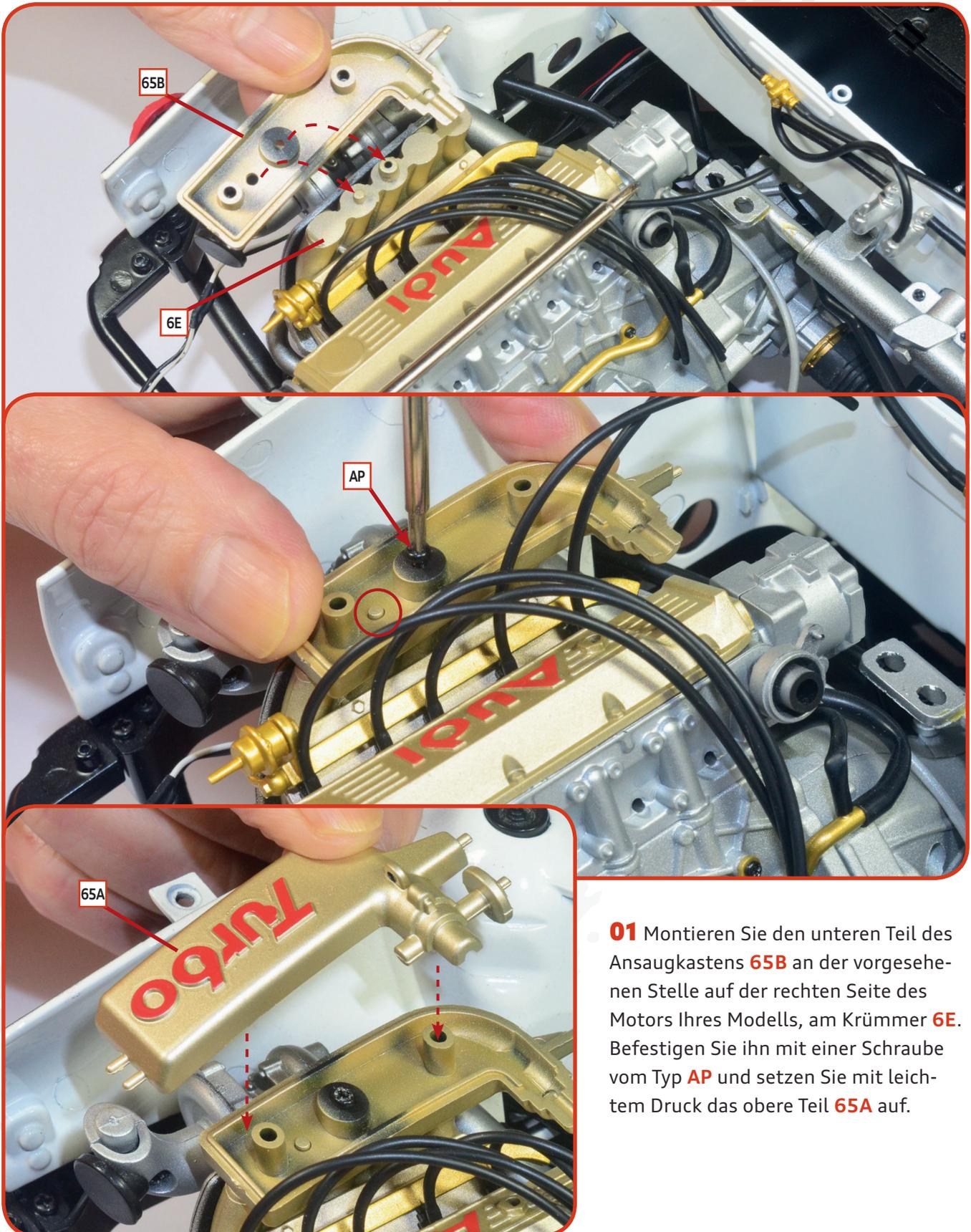
**01** Montieren Sie den unteren Teil des Ansaugkastens **65B** an der vorgesehenen Stelle auf der rechten Seite des Motors Ihres Modells, am Krümmer **6E**. Befestigen Sie ihn mit einer Schraube vom Typ **AP** und setzen Sie mit leichtem Druck das obere Teil **65A** auf.
