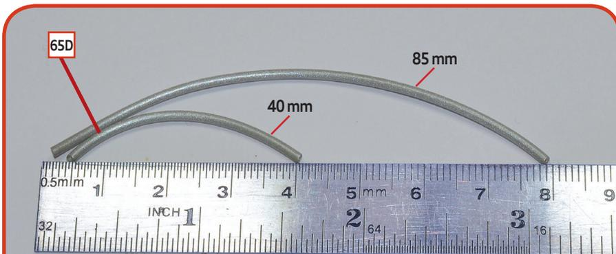
**03** Nehmen Sie ein 40 mm langes Segment und ein 85 mm langes Segment des Schlauchs **65D** zur Hand. Stecken Sie die Enden des 40-mm-Segments auf den Stift des Ansaugkastens und auf den Stift des Anschlusses der Einspritzleitung **64J**, so wie auf den Fotos.
