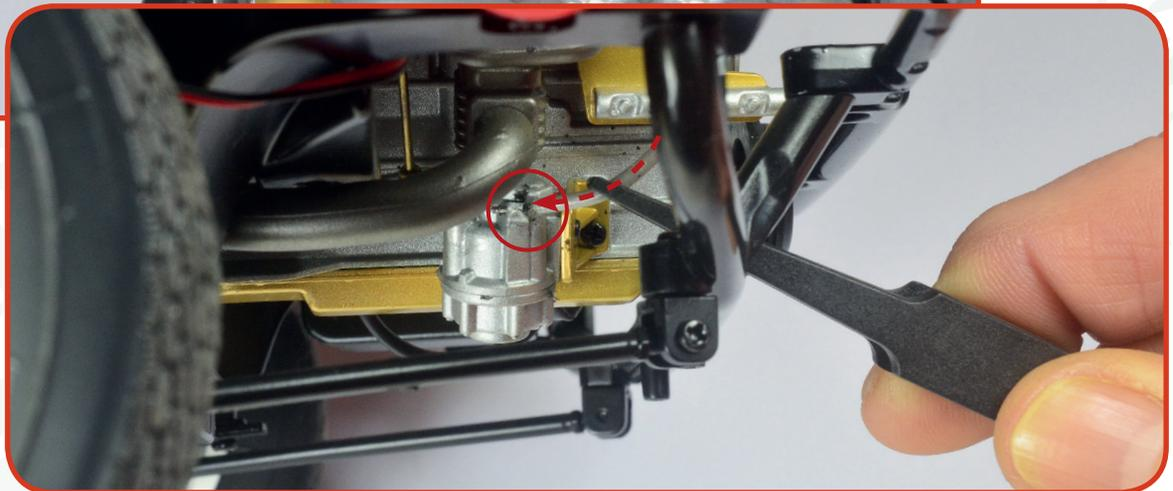
**04** Stecken Sie die Schlauchenden des 85-mm-Segments auf den verbleibenden Stift des Ansauggehäuses und auf den Stift, der aus dem Wastegate-Ventil (unterer Teil des Motors) herausragt, wie auf dem Foto gezeigt.
