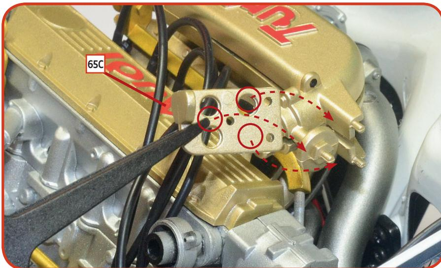
**02** Setzen Sie die kleineren Löcher der Platte **65C** auf die Stifte des Ansauggehäuses und richten Sie die Teile wie auf dem Foto gezeigt aus.
