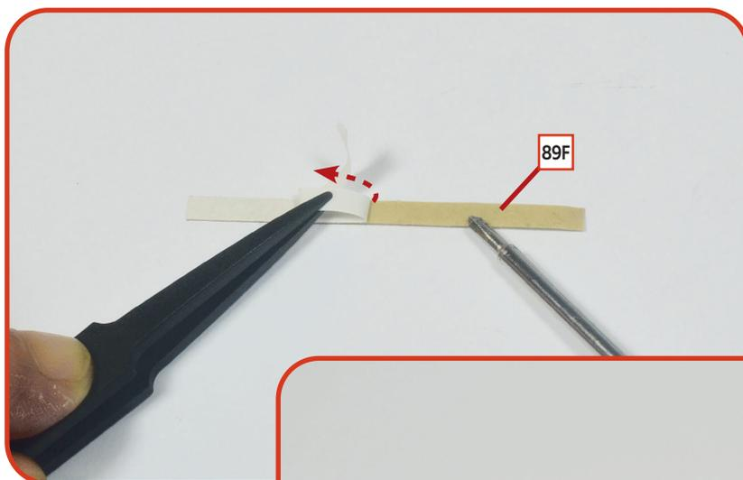
**04** Entfernen Sie die Schutzfolie von einer Seite des doppelseitigen Klebestreifens **89F** und kleben Sie ihn in der auf dem Foto gezeigten Position auf den Fensterrahmen.
