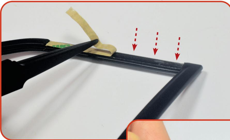
**05** Entfernen Sie jetzt die Schutzfolie des doppelseitigen Klebbandes und legen Sie die Fensterschieine **89B** darüber. Richten Sie die Teile wie auf dem Foto gezeigt aus.
