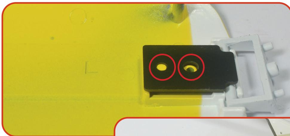
**03** Prüfen Sie, ob die Blattfeder korrekt positioniert ist und befestigen Sie sie mit einer der beiden **VM**-Schrauben an der Tür.
