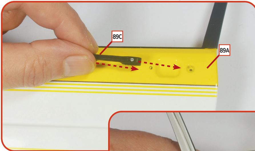
**01** Setzen Sie den Griff **89C** in die entsprechende Vertiefung an der Außenseite der linken Tür **89A** ein. Befestigen Sie den Griff, indem Sie eine **MP**-Schraube in der markierten Bohrung an der Innenseite der Tür anziehen.
