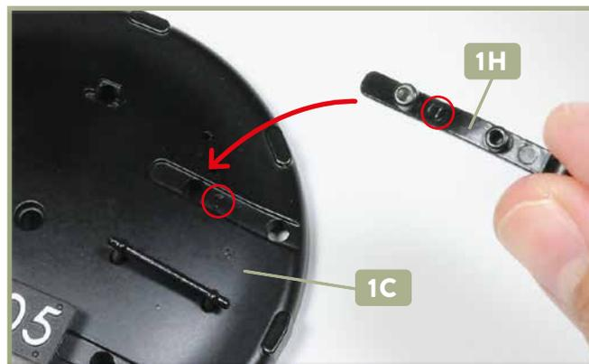
**6** Führen Sie das obere Türband **1H** (mit eingprägter 1, eingekreist) zur oberen Vertiefung an der Rauchkammertür **1C** (ebenfalls mit eingprägter 1, eingekreist).
