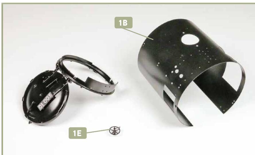
Die Rauchkammertür wurde mit dem Lokschild und drei Handgriffen versehen. Über ein Scharnier ist die Rauchkammertür drehbar mit der Türwand verbunden.
