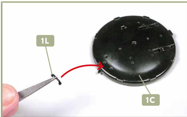
**1** Legen Sie die Rauchkammertür **1C** auf Ihre Arbeitsplatte. Versehen Sie die beiden Zapfen des seitlichen Handgriffs **1L** mit einer winzigen Menge Sekundenkleber und führen Sie das Teil zu den beiden Bohrungen der Rauchkammertür, wie es der Pfeil andeutet.
