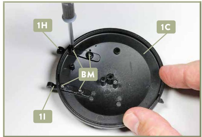
**8** Halten Sie die beiden Türbänder **1H** und **1I** in Position, während Sie die Rauchkammertür **1C** umdrehen. Befestigen Sie die beiden Türbänder mithilfe des Schraubendrehers **1N** mit den vier Schrauben **BM** an der Rauchkammertür.
