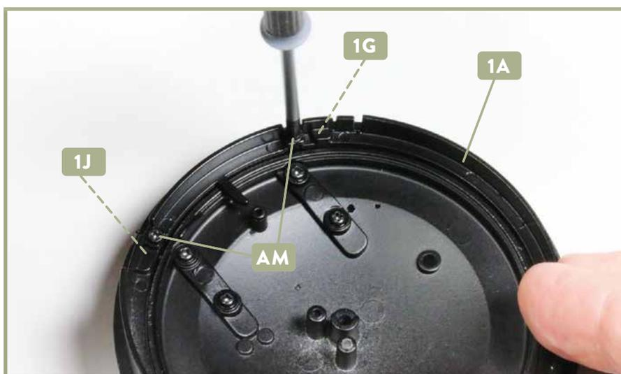
**14** Drehen Sie die Baugruppe vorsichtig um und fixieren Sie die beiden Wandbänder 1G und 1J mit jeweils einer Schraube AM an der Türwand 1A, wie abgebildet.
