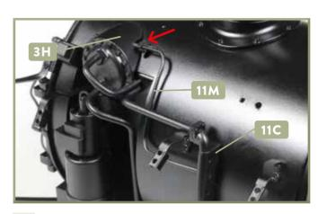
8 Versehen Sie die Zapfen am Ende der Leitung 11M mit etwas Sekundenkleber. Fixieren Sie die Leitung in der seitlichen Öffnung des Deckels 3H und der zweitobersten Bohrung des Austritts 11C. Achten Sie auf die Ausrichtung der Leitung (Pfeil).
