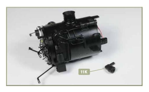
An der Rauchkammer-Baugruppe wurden weitere Abstandhalter, die Speisepumpe, der Turbogenerator und diverse Leitungen angebracht. Bewahren Sie die Wasserabführung 11K gut auf, sie wird in der folgenden Bauanleitung benötigt.
