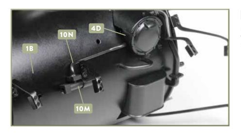
8 Wechsel auf die rechte Seite der Rauchkammer. Nehmen Sie die Dampfleitungs-Baugruppe 10 M/10 N zur Hand. Versehen Sie deren Zapfen mit etwas Sekundenkleber und fixieren Sie sie in den Bohrungen der Rauchkammer 1B bzw. des Deckels 4D, wie abgebildet.
