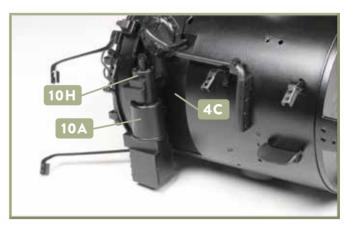
6 Fixieren Sie die Speisepumpe an der linken Rauchkammernische 4C, indem Sie die Zapfen an der Rückseite der Teile 10A und 10H in die Aufnahmen der Nische hineindrücken.
