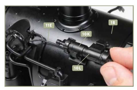
6 Die Turbogenerator-Baugruppe wird hinten auf der linken Seite der Rauchkammer 1B angebracht: Versehen Sie den Zapfen der Leitung 11E und die beiden Zapfen des Turbogenerators 10K mit etwas Klebstoff und fügen Sie sie in die Bohrungen der Rauchkammer ein, wie abgebildet.
