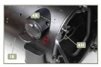
1 Wechsel auf die rechte Seite der Rauchkammer 1B. Öffnen Sie die Rauchkammertür. Drücken Sie leicht am Verschlussbalken 4H, bis die beiden Bohrungen der rechten Rauchkammernische 4B und die beiden (eingekreisten) Bohrungen der Rauchkammer fluchten.
