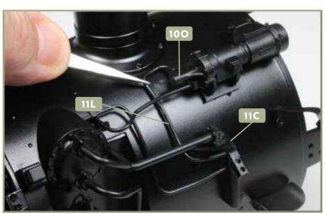
7 Nehmen Sie die Leitung 11L zur Hand und versehen Sie deren Enden mit etwas Klebstoff. Fixieren Sie das obere Ende der Leitung im Sackloch vom Vorderteil des Druckgenerators 10O. Das untere Ende wird in die oberste Bohrung des Austritts 11C eingefügt, wie es das Foto zeigt.
