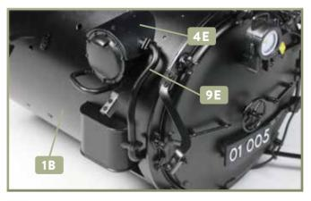
4 Nehmen Sie die Speiseleitung 9E und kleben Sie deren Endstücke in der Bohrung der Rauchkammer 1B bzw. des Deckels 4E fest, wie abgebildet.
