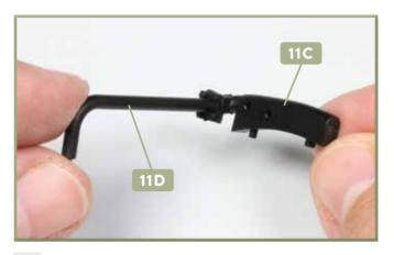
1 Versehen Sie den Zapfen der Frischdampfleitung 11D mit etwas Sekundenkleber und fügen Sie ihn in das Sackloch am Austritt der Dampfleitung 11C ein, wie abgebildet.
