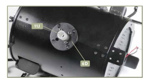
1 Drehen Sie die Rauchkammer-Baugruppe vorsichtig auf die Seite. Fügen Sie den Einsatz der Wasserabführung 11J in die große Öffnung der Ansatzfläche 6D ein.
