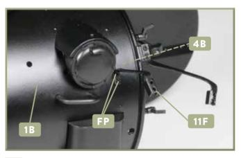
2 Nehmen Sie den rechten vorderen Abstandhalter 11F und befestigen Sie ihn mit zwei Schrauben FP an der Rauchkammer 1B bzw. der dahinter befindlichen Rauchkammernische 4B.
