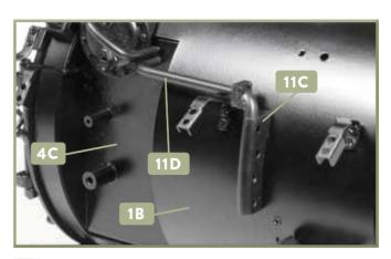
2 Geben Sie etwas Sekundenkleber auf die Zapfen der Teile 11C und 11D. Fixieren Sie die Teile auf der linken Seite der Rauchkammer 1B bzw. der linken Rauchkammernische 4C.
