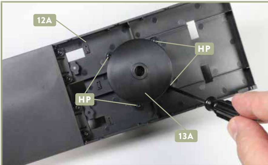
**2** Sitzt der Wasserkanister **13A** korrekt in der Aussparung des Bodenteils **12A**, fixieren Sie ihn mit vier Schrauben **HP**.
