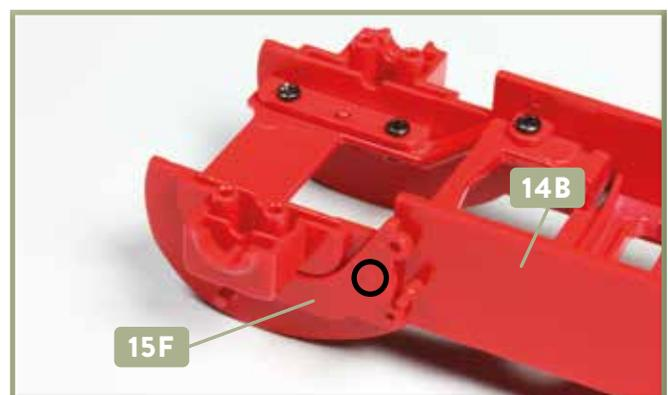
**6** Wir bleiben am rechten Rahmenteil **14B**: Nehmen Sie die Ansatzfläche **15F** (mit aufprägter „1“, im Bild eingekreist) und drücken Sie deren Zapfen vorsichtig in die Bohrung von **14B** hinein.
