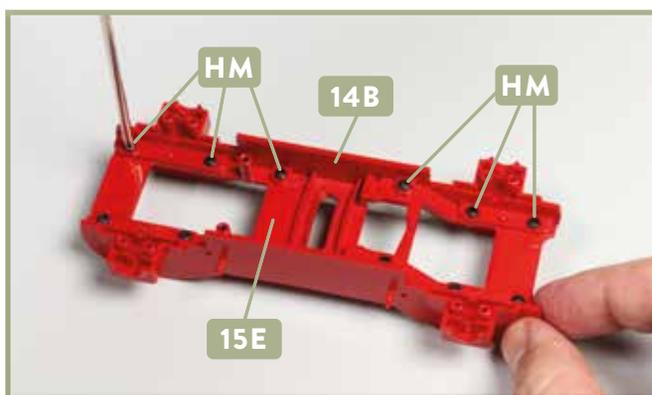
**5** Mit sechs Schrauben **HM** wird das rechte Rahmenteil **14B** am zentralen Rahmenteil **15E** fixiert.
