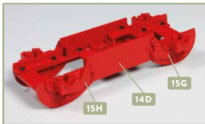
**8** Weiter geht es auf der linken Seite des Drehgestells. Am linken Rahmenteil **14D** werden die Ansatzflächen **15H** (mit aufgeprägter „4“) und **15G** (mit aufgeprägter „2“) angebracht.
