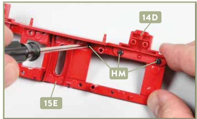
**2** Fixieren Sie das linke Rahmenteil **14D** im hinteren Bereich mit drei Schrauben **HM** am zentralen Rahmenteil **15E**.
