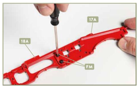
Fixieren Sie die beiden Rahmenteile 17A und 18A aneinander, indem Sie die zwei Schrauben FM eindrehen.
