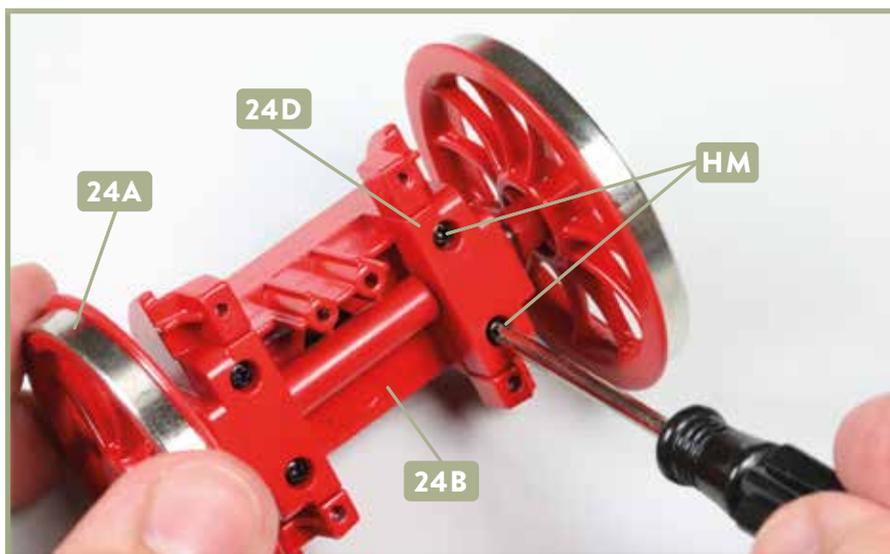
**8** Am anderen Ende des Achslagergehäuses **24B** wird ebenfalls eine Abdeckung **24D** aufgesetzt und mit zwei Schrauben **HM** befestigt. Die Achse des Nachlaufwads ist nun sicher mit dem Achslagergehäuse verbunden.
