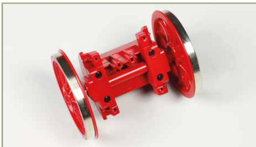
Das Nachlaufwrad ist mit seinem Achslagergehäuse zusammengefügt. Ein gefederter Drehzapfen ist am Achslagergehäuse befestigt.
