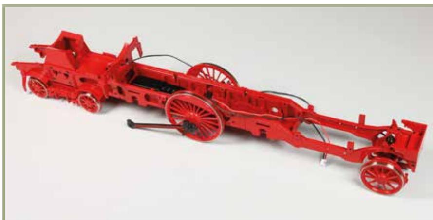
Die vordere Motor-Getriebe-Einheit ist zusammengefügt und im Rahmen montiert, der linke Bahnräumer wurde festgeklebt.
