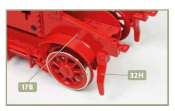
2 Der rechte Bahnräumer 32H wird in der Bohrung ganz vorne an der vorderen Rahmenverlängerung 17B festgeklebt.
