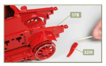
1 Weiter geht es am vorderen Ende des Rahmens, genauer gesagt an der rechten vorderen Rahmenverlängerung 17B. Legen Sie den rechten Bahnräumer 32H bereit und versehen Sie dessen Zapfen mit etwas Sekundenkleber.
