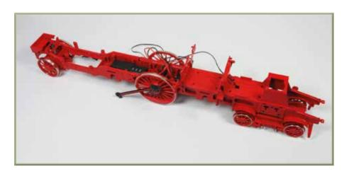
Die hintere Motor-Getriebe-Einheit ist zusammengefügt und im Rahmen montiert, der rechte Bahnräumer wurde angebracht.
