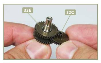
Nehmen Sie das zweite Zahnrad 32C und fügen Sie es mit dem Zahnrad mit Welle 32E zusammen. Achten Sie dabei auf die Ausrichtung der beiden Teile.
