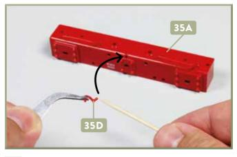
4 Nehmen Sie die Halterung 35D zur Hand, versehen Sie deren Zapfen mit Sekundenkleber und führen Sie ihn zur zentralen, kleinen Bohrung an der Vorderseite des Pufferträgers 35A, wie angedeutet.
