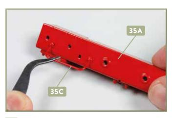
Versehen Sie die beiden Enden der ersten Griffstange 35C mit etwas Sekundenkleber und fügen Sie sie in die Bohrungen an der Unterseite des Pufferträgers 35A ein.
