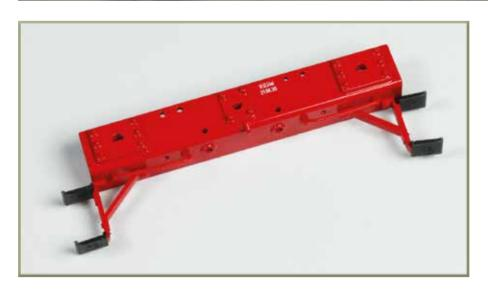
Die Arbeiten am Pufferträger haben begonnen: zwei Griffstangen, die beiden Rangiertritte und eine Halterung sind montiert.
