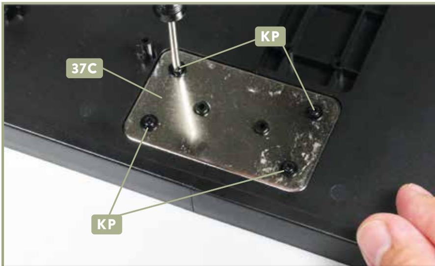
**4** Fixieren Sie den ersten Verbinder **37C**, indem Sie in seine vier äußeren Bohrungen je eine Schraube **KP** eindrehen, wie abgebildet.
