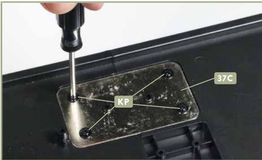
**5** Der zweite Verbinder **37C** wird ebenfalls mit vier Schrauben **KP** an den beiden Bodenteilen befestigt.
