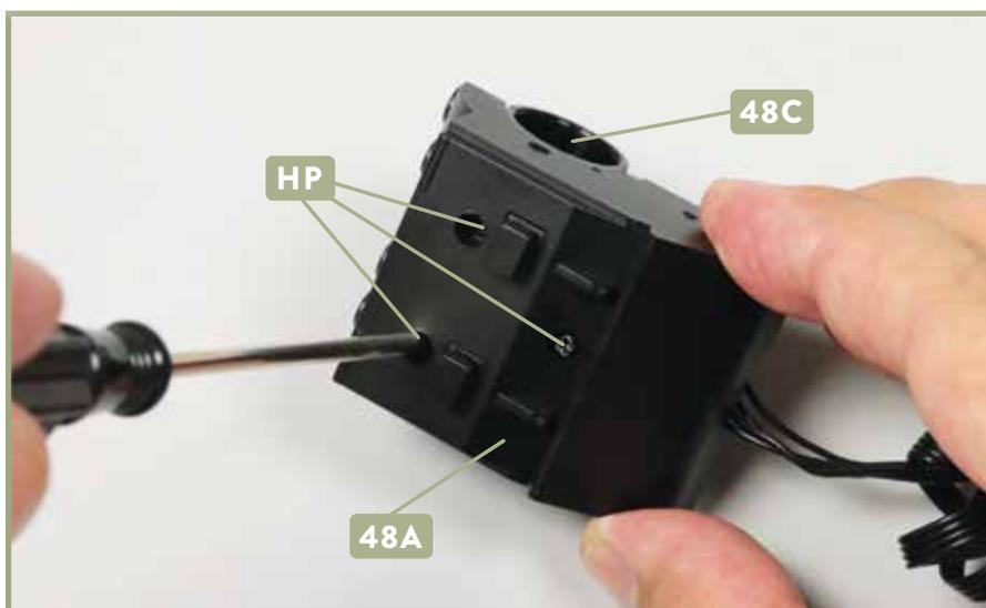
**3** Fixieren Sie den rechten Dampferzeuger **48C** an der Verkleidung **48A**, indem Sie die drei Schrauben **HP** in die Bohrungen der Verkleidung eindrehen.
