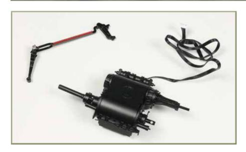
Die linke Zylinder-Schieberkasten-Baugruppe hat weiter Form angenommen. An der Schieberschubstange wurden der Voreilhebel und die Schwinge befestigt.
