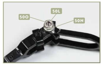
4 Platzieren Sie zunächst die Unterlegscheibe 50 N auf dem Ende des Schraubbolzens 500 und befestigen Sie dann die Mutter 50L am Gewinde, wie es das Foto zeigt. Die Verbindung bleibt beweglich.
