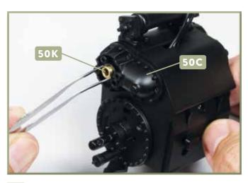
Setzen Sie den Messingring 50K in die Aufnahme des Schieberkastendeckels 50C.
