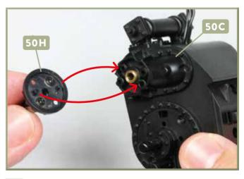
12 Fügen Sie die beiden unterschiedlich großen Zapfen an der Innenseite des Deckels 50H in die Aufnahmen der Basis 50C ein, auf die die Pfeile weisen.
