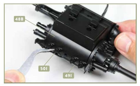
14 Nehmen Sie die Zylinderhähne mit Bedienungsstange 501 zur Hand. Drücken Sie deren vier Zapfen vorsichtig in die entsprechenden Bohrungen an der Unterseite der Verkleidungen 48B und 491 hinein. Es handelt sich um eine Steckverbindung.
