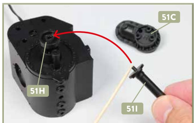
**6** Legen Sie den Schieberkastendeckel 51C bereit. Nehmen Sie das Kolbenstangenschutzrohr 51I, versehen Sie dessen Zapfen mit etwas Klebstoff und fügen Sie ihn in die Aufnahme der Stopfbuchse 51H ein, wie es der Pfeil andeutet.
