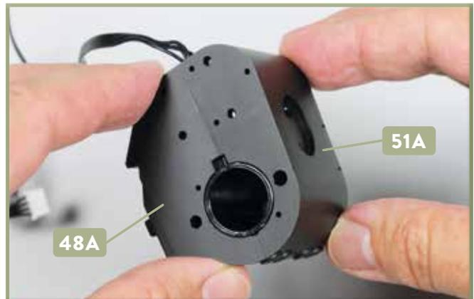
**2** Die Zylinderblockverkleidung 51A und die Verkleidung 48A sind zusammengefügt: Es handelt sich um eine Steckverbindung.
