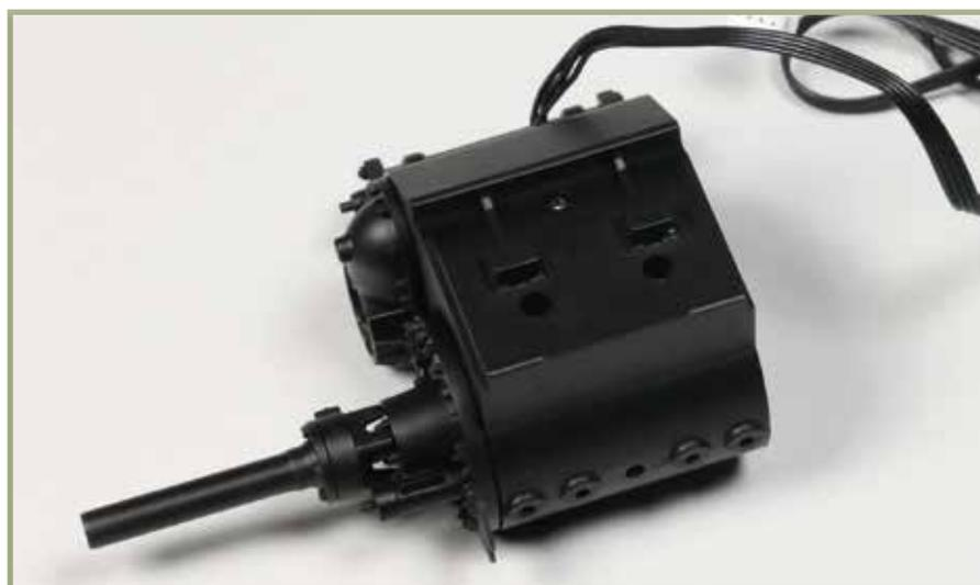
Die rechtsseitige Steuerung ist zusammengebaut: Am Zylinderblock wurden Deckel, das Kolbenstangenschutzrohr und der Druckausgleicher montiert.
