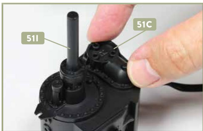
**7** Das Kolbenstangenschutzrohr **51I** ist fixiert. Drücken Sie die Zapfen an der Innenseite des Schieberkastendeckels **51C** in die Aufnahmen an der Vorderseite der Verkleidungen hinein.
