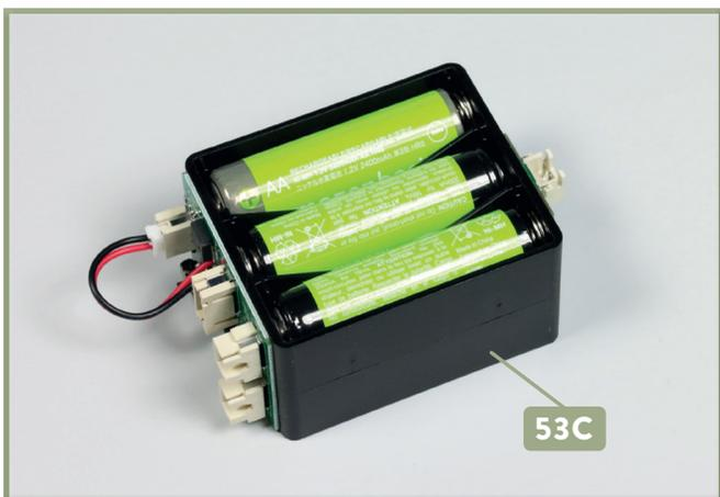
**9** Drehen Sie den Tester **53C** um und setzen Sie drei weitere Batterien AA in die Fächer auf dieser Seite des Testers ein.
