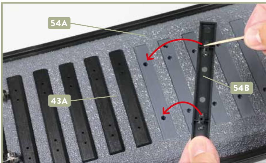
**4** Nehmen Sie die erste Schwelle **54B** zur Hand. Versehen Sie die beiden Zapfen an der Unterseite der Schwelle mit Sekundenkleber und fügen Sie diese in die Aufnahmen der Vertiefung ein, die sich sowohl auf dem vierten Bettungsabschnitt **54A** als auch auf dem dritten Bettungsabschnitt **43A** befindet, wie es die Pfeile andeuten.
