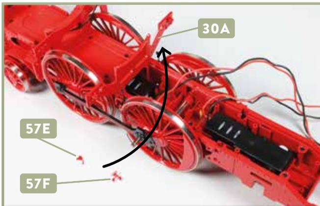
**1** Legen Sie die beiden Ölsperren **57E** und **57F** bereit. Sie gehören auf die Rückseite des vorderen Pendelblechs **30A**, wie es der Pfeil andeutet.
