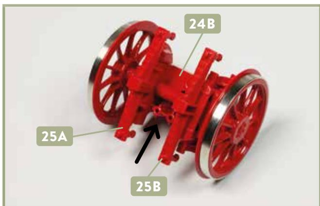
**5** Befestigen Sie die beiden Blattfedern **25A** und **25B** wieder in den Bohrungen an der Unterseite des Achslagergehäuses **24B**. Achten Sie auf die Ausrichtung des Achslagergehäuses: Die Seite mit den beiden Zapfen (Pfeil) muss am Modell nach vorne weisen.
