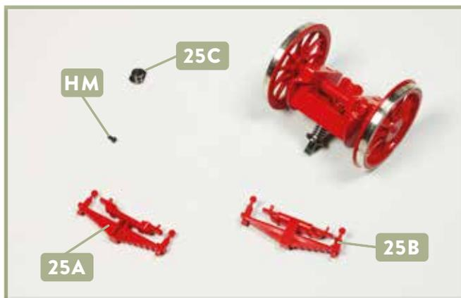
**2** Entfernen Sie den Nachlaufadsatz, die Aufnahme **25C** und die Schraube **HM** vom Rahmen des Modells. Lösen Sie vorsichtig die beiden Blattfedern **25A** und **25B** von der Baugruppe, wie abgebildet.
