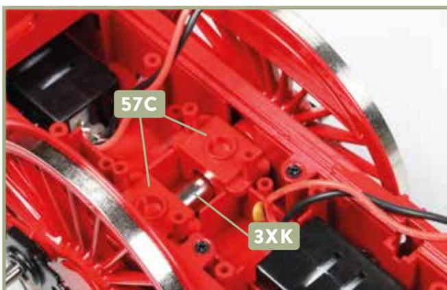
**5** Die erste Achslagerbase **57C** ist korrekt positioniert. Die zweite Achslagerbase **57C** wird über dem anderen Ende der Welle **3XK** platziert, wie abgebildet.
