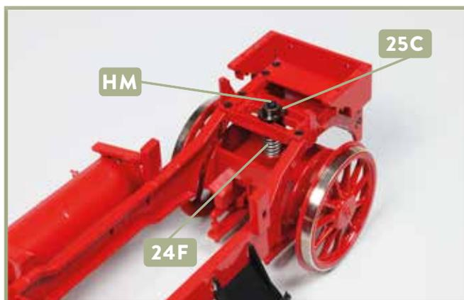
**6** Setzen Sie die Baugruppe wieder in den Rahmen ein, platzieren Sie die hintere Aufnahme **25C** auf dem oberen Ende des Drehzapfens **24F** und fixieren Sie diese mit der Schraube **HM**.
