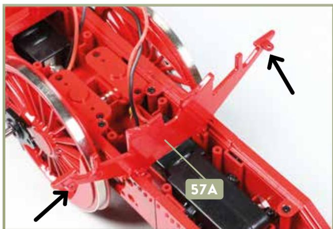
**9** Das hintere Pendelblech **57A** ist korrekt in den Rahmen eingefügt: Achten Sie darauf, dass die Laschen des Blechs, auf die die beiden Pfeile zeigen, in Richtung Heck des Modells weisen.
