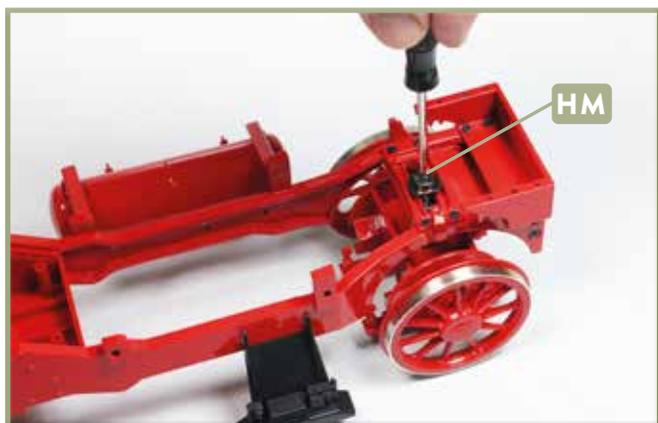
**1** Stellen Sie das Fahrwerk Ihrer Lok auf Ihre Arbeitsplatte und wenden Sie sich dem Nachlaufadsatz zu: Drehen Sie die Schraube **HM** aus dem Drehzapfen heraus.
