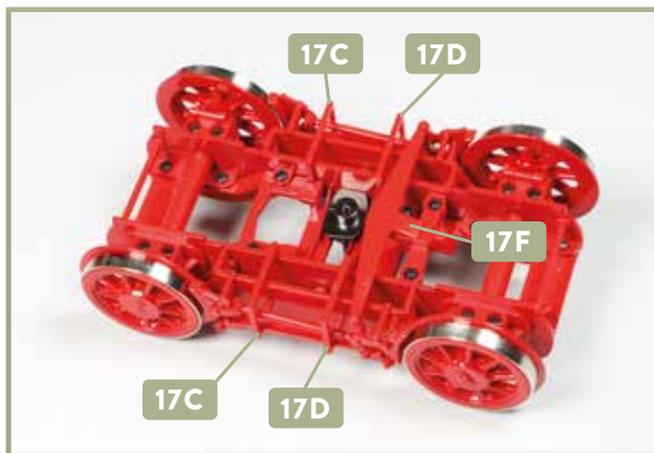
**10** Bringen Sie auf beiden Seiten des Drehgestells je einen Bügel **17C** und **17D** an. Anschließend wird der Querträger **17F** ebenfalls wieder am Drehgestell befestigt.
