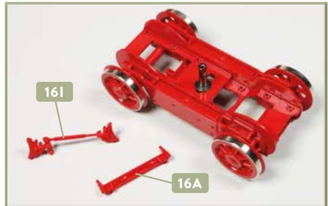
**4** Wechsel auf die rechte Seite des Drehgestells, von der Sie das Bremsgestänge **16I** und anschließend die Verstärkung **16A** abnehmen, wie abgebildet. Die Teile werden nicht mehr benötigt.
