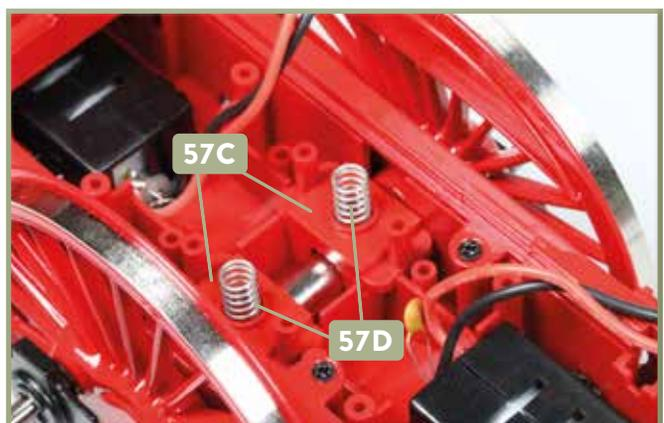
**6** In die Vertiefung der beiden Achslagerbasen **57C** wird jeweils eine Feder **57D** gesetzt, wie es das Foto zeigt.
