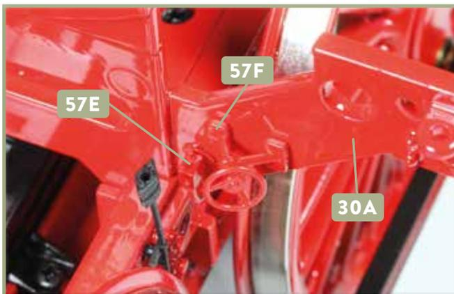
**3** Die Ölsperre **57E** ist am Pendelblech **30A** festgeklebt. Geben Sie etwas Sekundenkleber auf die beiden Zapfen der Ölsperre **57F** und fixieren Sie diese ebenfalls am Pendelblech, wie abgebildet.
