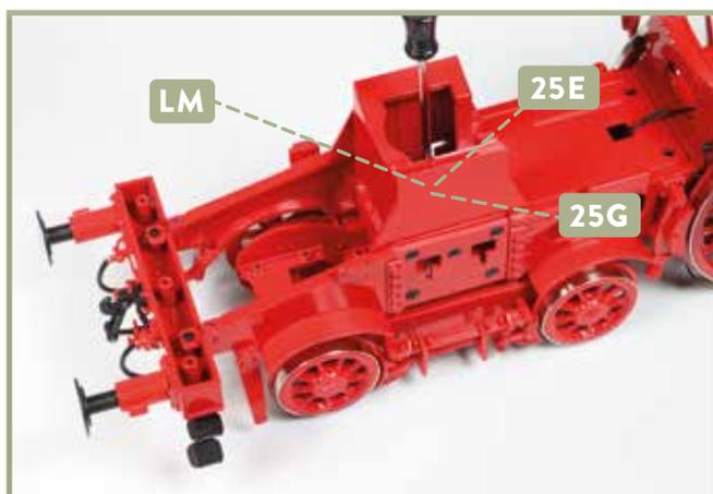
**12** Positionieren Sie den Drehzapfen **25G** unter der Bohrung im Rahmen. Setzen Sie die Unterlegscheibe **25E** auf den Schaft der Schraube **LM** und drehen Sie sie in den Drehzapfen **25G** hinein.
