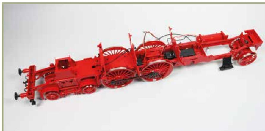
Der Austausch vom Nachlaufbandsatz sowie von den Radsätzen des Drehgestells ist vollzogen. Das Kuppelrad hat seine Lagerung erhalten, das hintere Pendelblech ist montiert.
