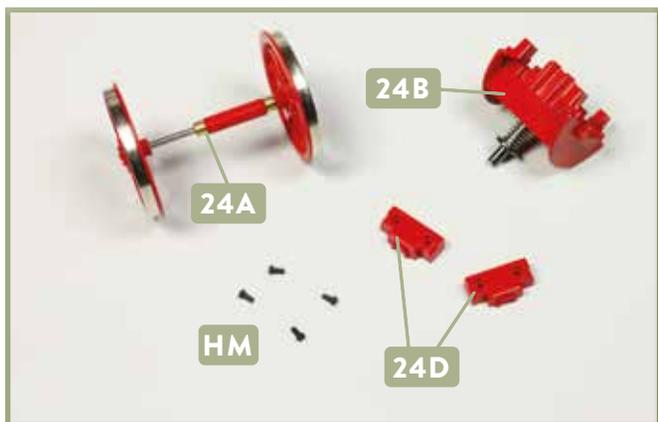
**3** Lösen Sie die je zwei Schrauben **HM** und nehmen Sie die beiden Abdeckungen **24D** von der Baugruppe ab. Legen Sie nun den Nachlaufadsatz **24A** beiseite, er wird nicht mehr benötigt.
