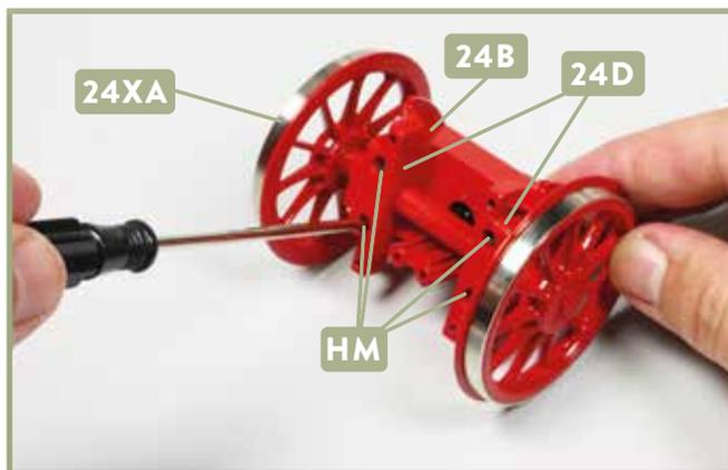
**4** Fügen Sie den neuen Nachlaufadsatz **24XA** in das Achslagergehäuse **24B** ein. Setzen Sie die beiden Abdeckungen **24D** wieder auf und fixieren Sie sie mit den vier Schrauben **HM**.
