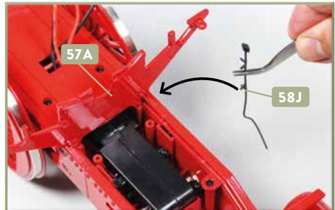
**4** Nehmen Sie das Sandfallrohr **58J**, versehen Sie dessen zwei seitliche Zapfen mit etwas Sekundenkleber und führen Sie sie auf Höhe des hinteren Pendelblechs **57A** zur rechten Rahmenseite, wie es der Pfeil andeutet.
