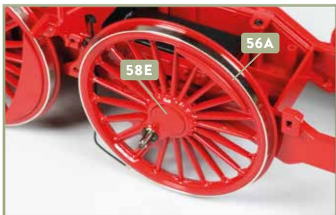
**3** Drücken Sie den Nabendeckel **58E** in die Bohrung des Kuppelrads **56A** hinein, wie abgebildet. (Ggf. festgeklebt werden die Nabendeckel erst nach dem Funktionstest des kompletten Fahrwerks, der in Ausgabe 62 erfolgen wird.)
