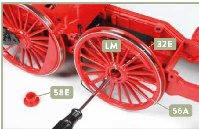
**2** Fixieren Sie das Kuppelrad **56A** mit einer Schraube **LM** an der Welle **32E**. Legen Sie den Nabendeckel **58E** bereit.
