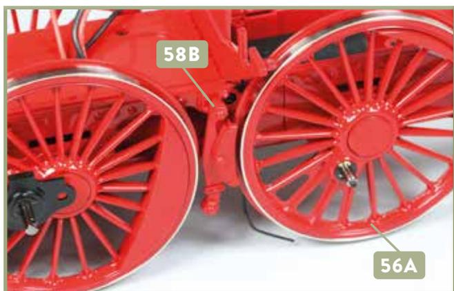
**5** Versehen Sie die beiden Zapfen des ersten Bremsgestänges **58B** mit etwas Sekundenkleber und fügen Sie sie in die Bohrungen ein, die sich unmittelbar vor dem Kuppelrad **56A** im Rahmen befinden.
