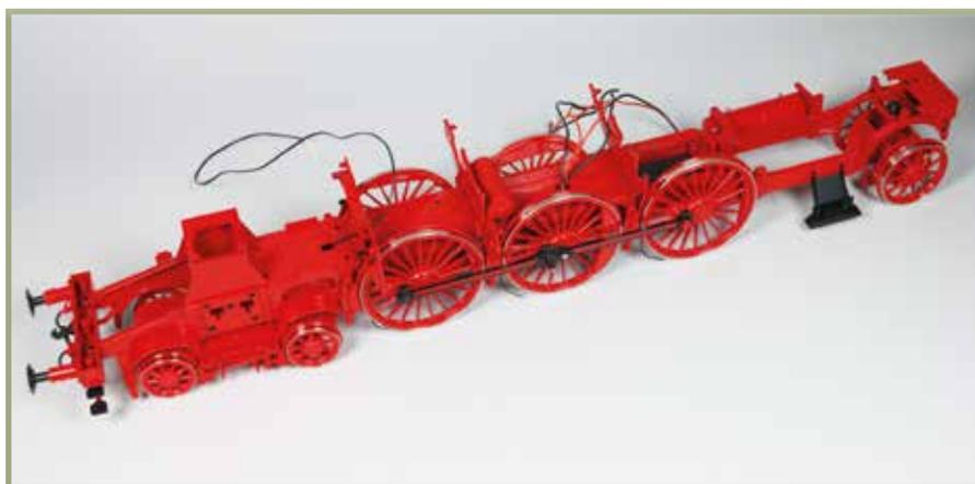
Das hintere linke Kuppelrad ist montiert und mit dem benachbarten Kuppelrad verbunden.
