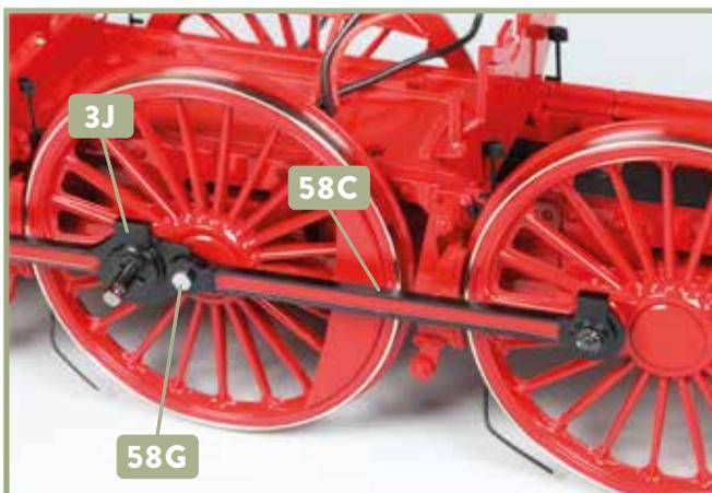
**11** Fluchten die beiden Kuppelstangen **58C** und **3J**, verbinden Sie sie mithilfe des Bolzens **58G**.
