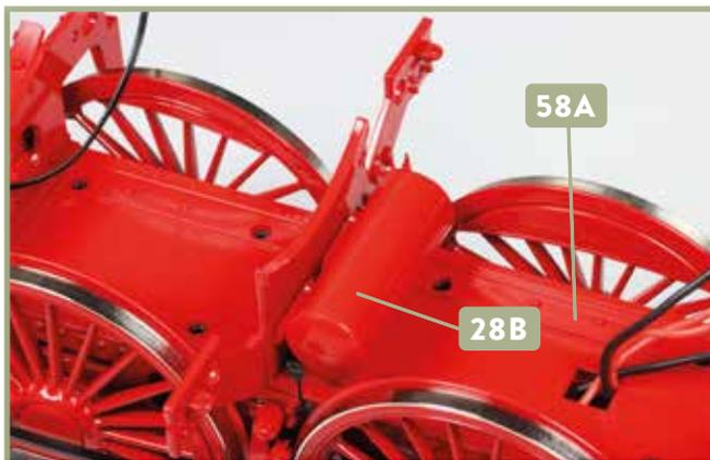
**2** Kleben Sie den Hilfsluftbehälter 28B in den beiden Bohrungen fest, die sich vorne in der Abdeckung 58A befinden.
