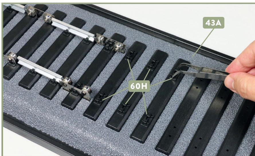
**4** Fixieren Sie die sechs Kleineisen **60H** an den nächsten freien Schwellen des dritten Bettungsabschnitts **43A**. Versehen Sie zuvor die Zapfen der Kleineisen jeweils mit etwas Sekundenkleber.
