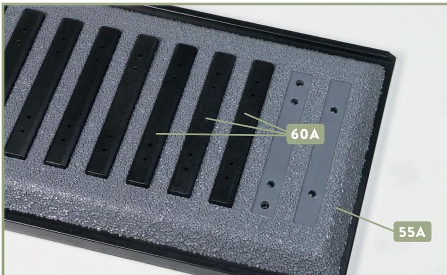
**2** Die erste Schwelle **60A** ist an der Bettung **55A** befestigt. Wiederholen Sie den Arbeitsschritt mit der zweiten und dritten Schwelle: Diese werden in den nächsten freien Vertiefungen der Bettung festgeklebt, wie abgebildet.
