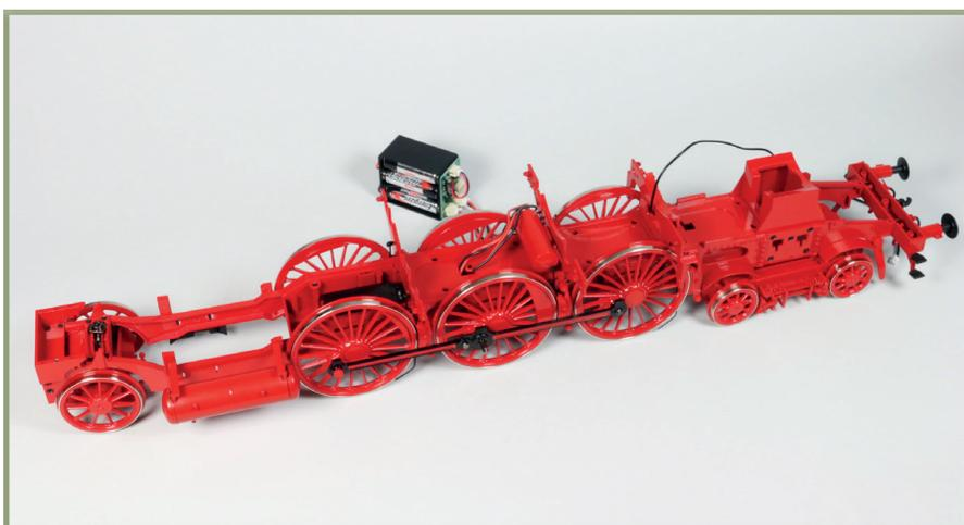
Die letzte Kuppelstange ist auf der rechten Fahrwerksseite angebracht. Drei weitere Schwellen und sechs Kleineisen sind am Gleisbett montiert (nicht abgebildet).
