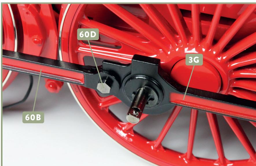
**5** Fluchten die beiden Kuppelstangen **60B** und **3G**, verbinden Sie sie mithilfe des Bolzens **60D**.
