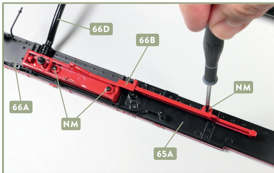
**11** Befestigen Sie den Schwingenträger 66B mit drei Schrauben NM an der Unterseite des Umlaufblechs 65A bzw. 66A. Das hintere Ende des Schwingenträgers sitzt über dem Bügel des Querträgers 66D, wie es das Foto zeigt.
