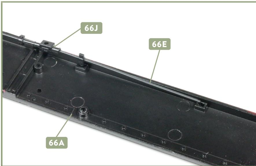
**7** Nehmen Sie die Luftleitung **66E** und versehen Sie deren vorderes Ende sowie deren langes Zapfenende mit etwas Sekundenkleber. Das Leitungsende wird an der Aufnahme der Luftleitung **66J** fixiert, der Zapfen in der Aufnahme des Umlaufblechs **66A**.
