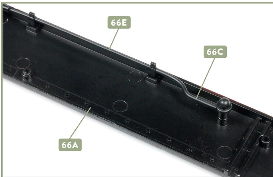
**8** Die Luftleitung **66C** wird an der Luftleitung **66E** und an der Aufnahme des Umlaufblechs **66A** festgeklebt.
