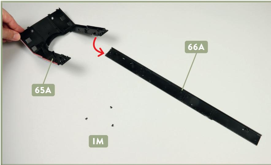
**1** Legen Sie drei Schrauben **IM** und das linke Umlaufblech **66A** (mit der Oberseite nach unten) auf Ihre Arbeitsplatte. Nehmen Sie die Frontverkleidung **65A** und fügen Sie sie mit dem Umlaufblech zusammen, wie es der Pfeil andeutet.
