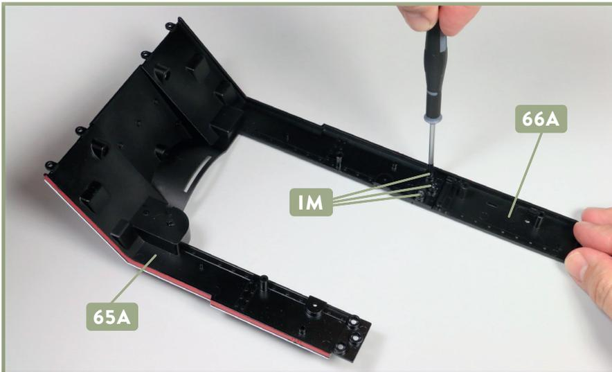
**2** Fixieren Sie die Frontverkleidung **65A** am Umlaufblech **66A**, indem Sie drei Schrauben **IM** in die Bohrungen der beiden Teile eindrehen, wie abgebildet.
