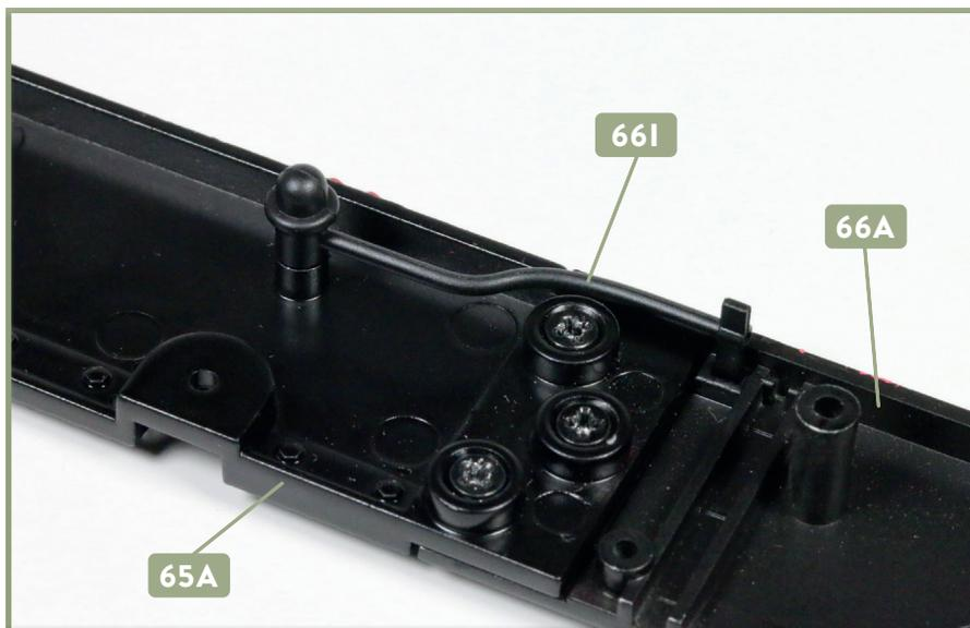
**4** Die Luftleitung **66I** ist korrekt an beiden Teilen des Umlaufblechs, **65A** und **66A**, festgeklebt.
