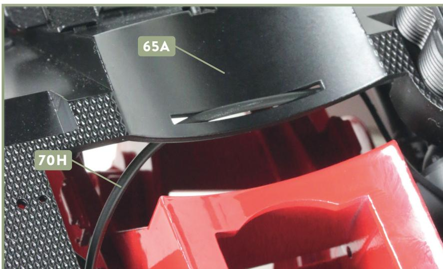
**3** Führen Sie die Dampfleitung **70H** durch den länglichen Schlitz der Frontverkleidung **65A** (damit er sich besser zur linken Rahmenseite verlegen lässt) und dann an der linken Rahmenseite nach hinten.
