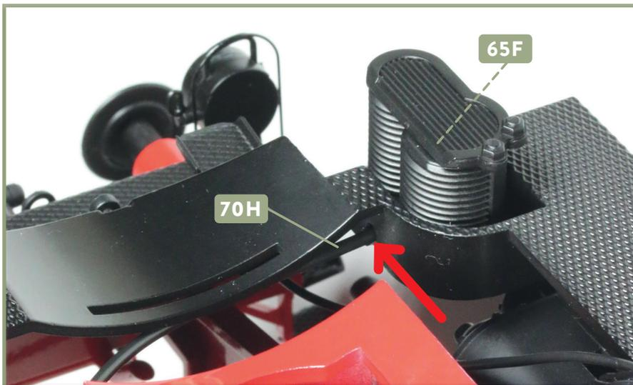
**2** Versehen Sie ein Ende der Dampfleitung **70H** mit etwas Sekundenkleber und fixieren Sie es am Zapfen, der sich seitlich an der Bodenplatte der Luftpumpe **65F** befindet. Der Pfeil weist auf diese Stelle.
