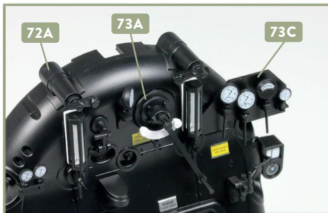
**8** Der Reglerhebel **73A** ist an der Stehkesselrückwand **72A** befestigt. Rechts daneben wird das Schieberkastenmanometer **73C** festgeklebt, wie abgebildet.
