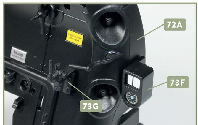
**6** Das Luftleitungsmanometer 73F ist an der Stehkesselrückwand 72A fixiert. Unweit davon wird das Luftpumpenventil 73G festgeklebt, wie abgebildet.
