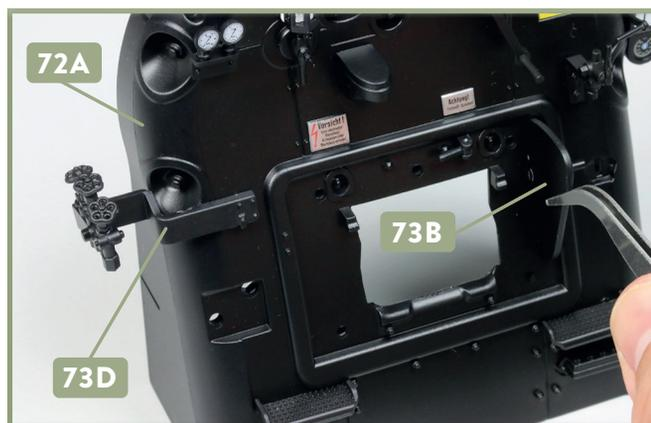
**10** Der Halter **73D** wird ganz links an der Stehkesselrückwand **72A** festgeklebt. Versehen Sie die beiden Zapfen der Seitenblende **73B** mit Sekundenkleber und fügen Sie diese in die Schlitz ein, die sich rechts neben der Feuertür in der Stehkesselrückwand befinden.
