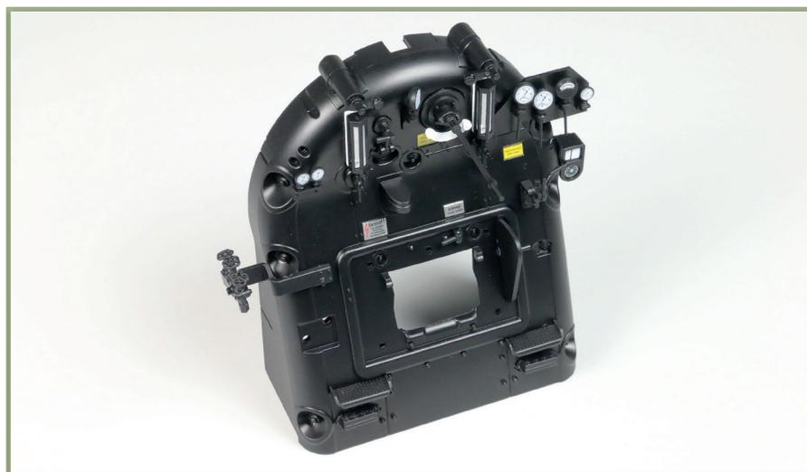
Die Arbeiten an der Stehkesselrückwand sind fortgeschritten: Hebel, Manometer, Ventile und die beiden Wasserstandsgläser wurden montiert.
