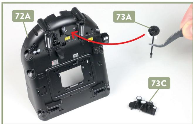
**7** Legen Sie den Reglerhebel **73A** und das Schieberkastenmanometer **73C** bereit. Geben Sie etwas Sekundenkleber auf die beiden Zapfen an der Rückseite von **73A** und fügen Sie diese in die Bohrungen an der Stehkesselrückwand **72A** ein, auf die der Pfeil weist.
