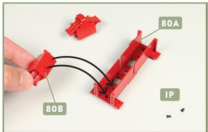
**4** Legen Sie die Drehgestellwiege **80A** und zwei Schrauben **IP** bereit. Fügen Sie die Zapfen an der Unterseite der Blattfeder **80B** in die Aufnahmen der Wiege ein, wie es die Pfeile andeuten.
