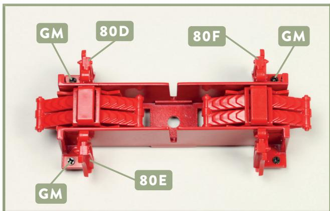
**9** Die anderen drei Bremsklötze **80D**, **80E** und **80F** werden an den anderen Vorsprüngen der Drehstellwiege **80A** mit je einer der Schrauben **GM** fixiert.
