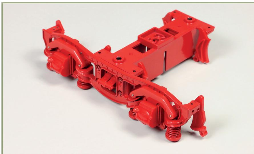
Die Drehstellwiege wurde mit Bremsklötzen und Blattfedern versehen und ist am linken Drehgestellrahmen befestigt.
