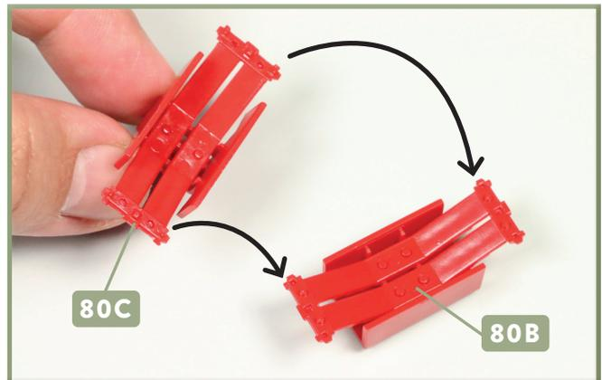
**2** Nehmen Sie ein Blattfeder-Unterteil **80C** und versehen Sie die je drei Zapfen an den beiden Enden mit etwas Sekundenkleber. Fügen Sie die Zapfen in die Vertiefungen vom Blattfeder-Oberteil **80B** ein, wie es die Pfeile andeuten.
