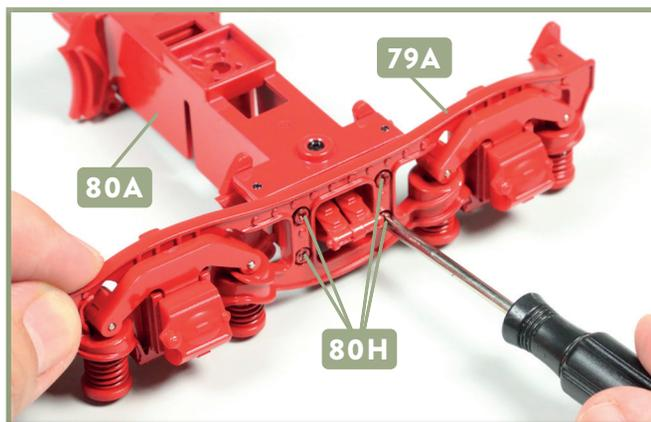
**10** Nehmen Sie den linken Drehgestellrahmen **79A**, setzen Sie ihn auf das eine Ende der Drehstellwiege **80A** und befestigen Sie ihn mit vier rot gefärbten Schrauben **80H**.
