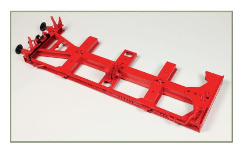
Der Zusammenbau des Tenderrahmens schreitet voran: Der linke Längsträger wurde montiert.
