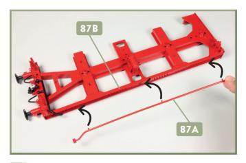
Geben Sie etwas Sekundenkleber auf die drei Zapfen der Bremsluftleitung 87A und fügen Sie diese in die Bohrungen des Längsträgers 87B ein, wie es die Pfeile andeuten.
