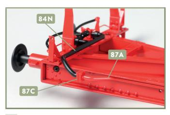
7 Am hinteren Ende der Bremsluftleitung 87A wird die Halterung 87C mit der Bremsluftleitung 84N verbunden.
