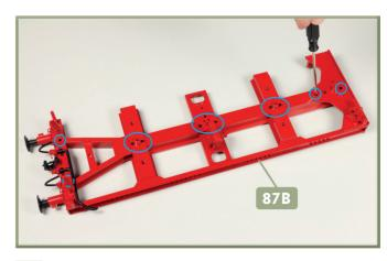
2 Lässt sich der Längsträger 87B nicht an allen Stellen leicht in die Baugruppe einfügen, lösen Sie die blau umkreisten Schrauben leicht an.
