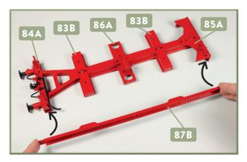
Legen Sie die Tenderrahmen-Baugruppe verkehrt herum bereit. Fügen Sie den linken Längsträger 87B so in die Baugruppe ein, dass seine Bohrungen mit denen der Querträger 83B und 86A sowie des Pufferträgers 84A und des Rahmenabschlusses 85A fluchten.
