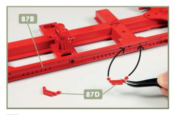
Legen Sie die beiden Schmiergefäße 87D bereit. Versehen Sie die Zapfen des ersten mit etwas Sekundenkleber und fügen Sie sie in die Bohrungen des Längsträgers 87B ein, wie es die Pfeile andeuten.
