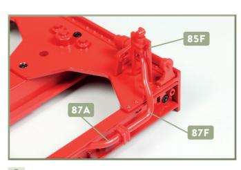
Am vorderen Ende der Bremsluftleitung 87A wird das Übergangselement 87F fixiert. Das andere Ende des Elements gehört in die Aufnahme an der Unterseite der Stütze 85F.
