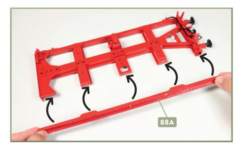
Legen Sie die Tenderrahmen-Baugruppe verkehrt herum auf Ihre Arbeitsplatte. Fügen Sie den rechten Längsträger 88Å so in die Baugruppe ein, dass seine Bohrungen mit denen der Querträger sowie des Pufferträgers und des Rahmenabschlusses fluchten, wie es die fünf Pfeile andeuten.
