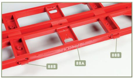
5 Legen Sie die beiden Schmiergefäße 88B bereit. Versehen Sie die Zapfen mit etwas Sekundenkleber und fügen Sie sie in die Bohrungen des Längsträgers 88A ein. Achten Sie auf die Ausrichtung der beiden Schmiergefäße: Die Seite mit den kleinen Zapfen weist jeweils nach unten.
