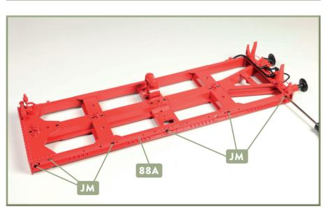
3 Fixieren Sie den Längsträger 88A, indem Sie sechs Schrauben JM in seine Bohrungen eindrehen. Ziehen Sie anschließend auch die mit Schritt 2 angelösten Schrauben wieder an.
