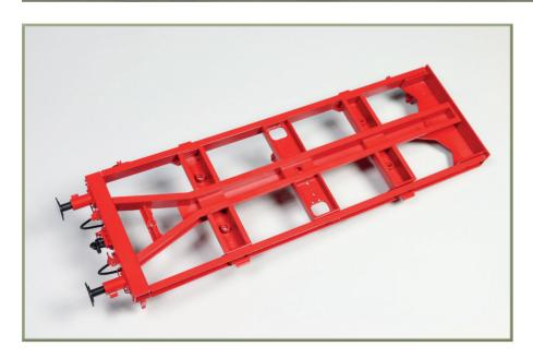
Der Zusammenbau des Tenderrahmens nähert sich dem Ende: Der rechte Längsträger wurde montiert.
