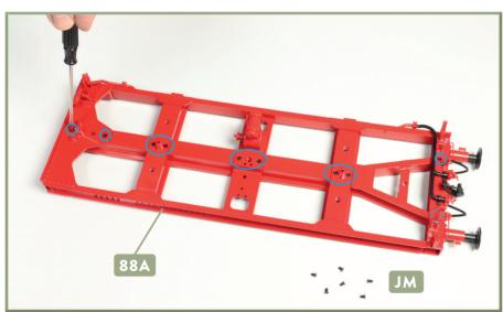
2 Lässt sich der Längsträger 88A nicht an allen Stellen leicht in die Baugruppe einfügen, lösen Sie die blau umkreisten Schrauben leicht an: Die betroffenen Bauteile haben nun etwas Spiel und der Längsträger lässt sich akkurater platzieren. Legen Sie sechs Schrauben JM bereit.
