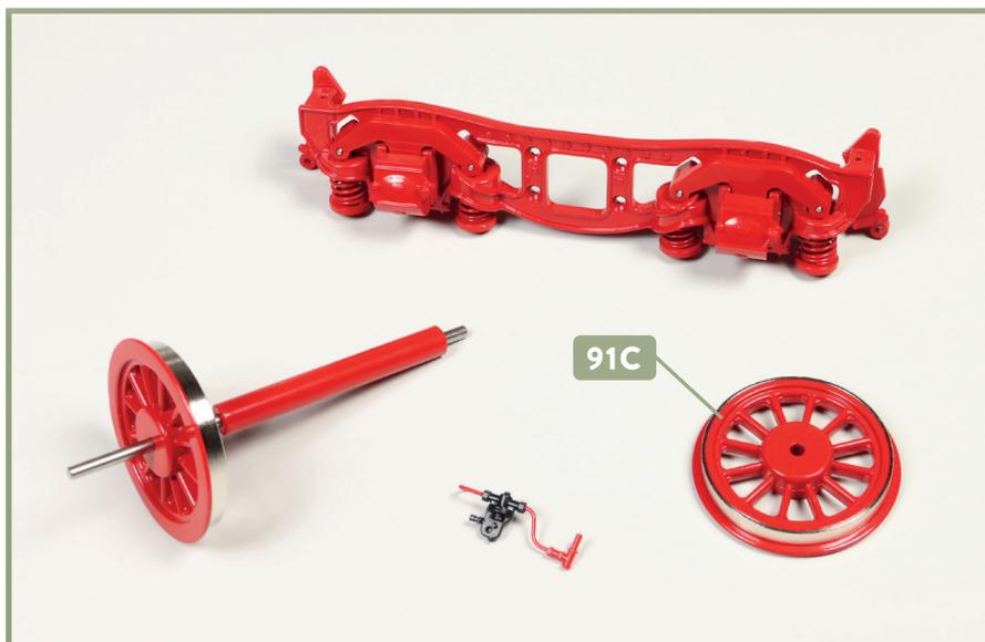
Am rechten Drehgestellrahmen sind Bremsklötze, Spiralfedern und Achslagerdeckel angebracht. Die Welle wurde für den Einbau in den Rahmen vorbereitet. Das zweite Rad **91C** wird erst mit der folgenden Bauanleitung benötigt.
