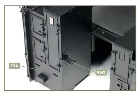
9 Stellen Sie den Behälter des Tenders 93A so auf Ihre Arbeitsplatte, dass Sie Zugriff auf dessen Vorderseite haben. Nehmen Sie die Trittfläche 95G und kleben Sie deren Zapfen in der Bohrung vorne mittig am Tenderbehälter fest, wie abgebildet.
