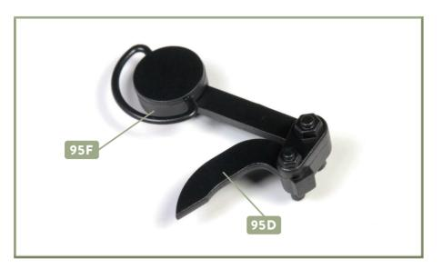
10 Nehmen Sie das Gegengewicht 95F und kleben Sie es in der Aufnahme des Hebelwerks der Wurfhebelbremse 95D fest, wie es das Foto zeigt.
