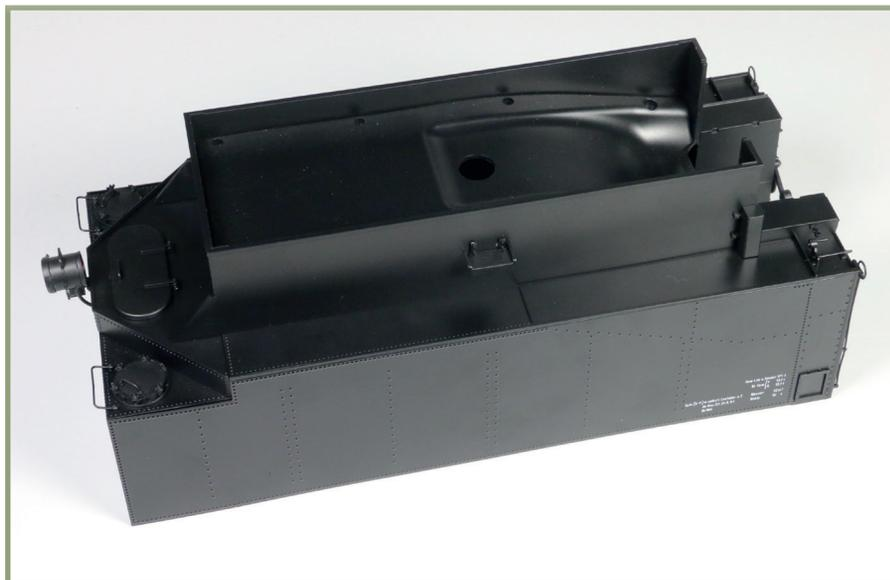
Das Kabel der oberen Loklaterne wurde ins Tenderinnere geführt. Das Tenderinnenteil ist am Behälter des Tenders fixiert. Zwei Trittbleche und ein Windabweiser sind montiert.
