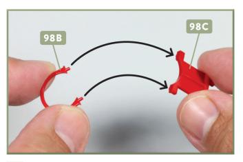
1 Nehmen Sie die Schelle 98B, versehen Sie deren zwei Zapfen mit etwas Sekundenkleber und fügen Sie diese in die Bohrungen der Halterung 98C ein, wie es die Pfeile andeuten.
