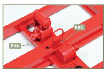
3 Die Halterung 98C ist mittig zwischen den beiden Bremszylindern auf dem Querträger 86A fixiert.
