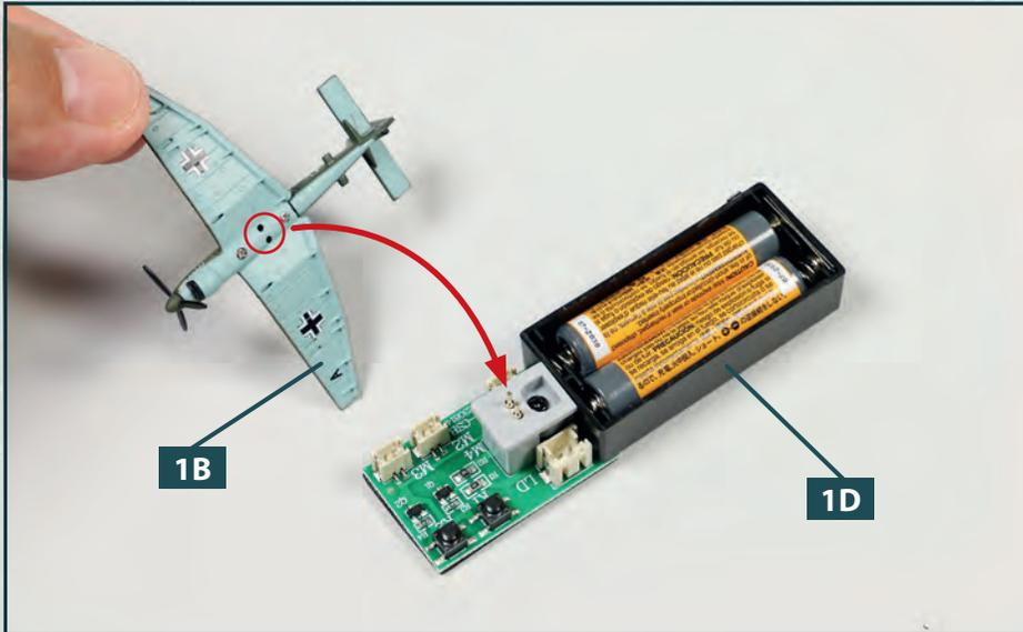
**5** Platzieren Sie die beiden Vertiefungen an der Rumpfunterseite der Ju 87 **1B** (eingekreist) auf den beiden goldfarbenen Kontakten der Testplatine **1D**, auf die der Pfeil weist.
