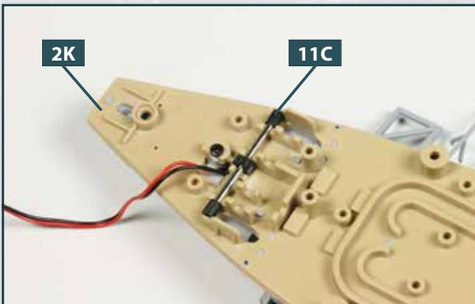
**3** Drehen Sie den Unterdeckabschnitt **2K** um und lagern Sie ihn wieder auf einer weichen Unterlage. Setzen Sie die Welle mit Zahnrad **11C** in die Aufnahme im vorderen Bereich der Decksunterseite ein.
