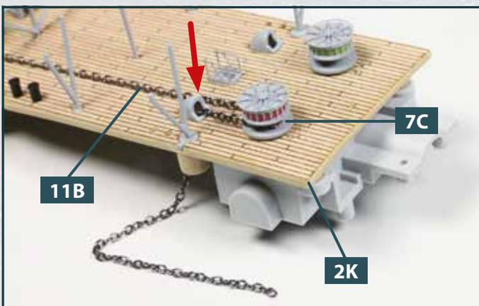
Das freie Ende der Ankerkette **11B** wird um die Spillwelle **7C** herumgelegt und anschließend durch die Öffnung des Ankerketteneinlaufs, auf den der Pfeil weist, nach unten geführt.
