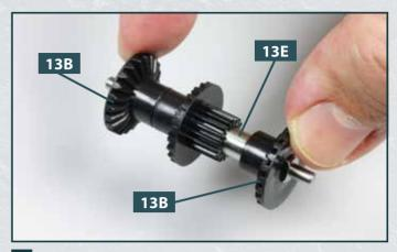
8 Nehmen Sie die beiden Kegelräder **13B** und bringen Sie je eines von ihnen an beiden Enden der Welle **13E** an. Achten Sie auf die Ausrichtung der Kegelräder und schieben Sie sie bis zum Anschlag durch, wie abgebildet.
