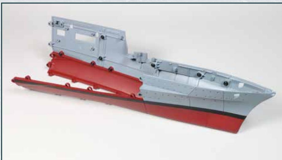
Auf der Steuerbordseite der Rumpfstruktur ist ein weiterer Abschnitt angefügt und befestigt.
