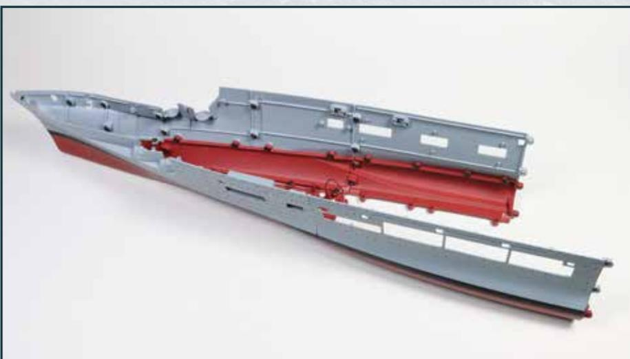
Auf der Steuerbordseite der Rumpfstruktur wurde ein weiterer oberer Abschnitt angebracht.
