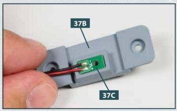
Positionieren Sie die LED-Platine **37C** in der Aufnahme der Halterung **37B**: Achten Sie dabei darauf, dass die LED-Seite mit den Kabeln nach oben weist, wie abgebildet.
