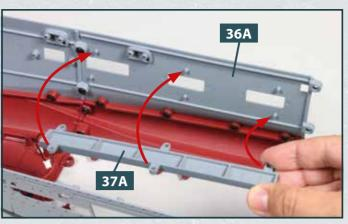
Nehmen Sie die Abdeckung **37A** und platzieren Sie sie so auf dem rechten oberen Rumpfabschnitt **36A**, dass die sechs Laschen die sechs Zapfen umfassen, wie es die Pfeile andeuten.
