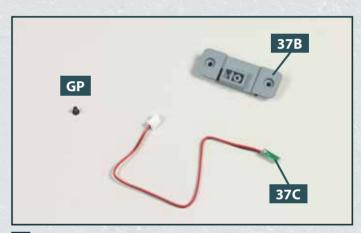
4 Legen Sie die LED-Platine **37C**, die Halterung **37B** und eine Schraube **GP** bereit.
