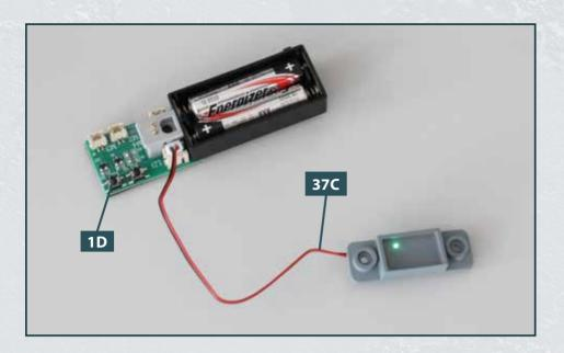
7 Jetzt wird die LED **37C** getestet. Verbinden Sie dazu den Stecker des Platinenkabels mit dem Port "LD" der Testplatine **1D**. Sobald dies geschehen ist, leuchtet die LED grün auf. Trennen Sie das Kabel der LED-Platine nach erfolgreichem Funktionstest wieder von der Testplatine.
