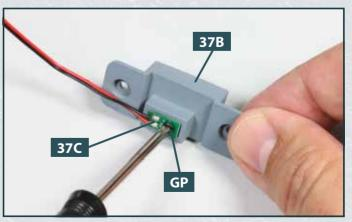
6 Befestigen Sie die LED-Platine **37C** mit der Schraube **GP** an der Halterung **37B**.
