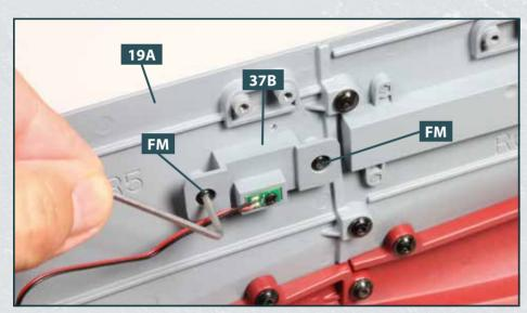
8 Platzieren Sie die Halterung **37B** von innen über der Öffnung im rechten oberen Rumpfabschnitt **19A**. Fixieren Sie die Halterung mit zwei Sechskantschrauben **FM**, die Sie mit dem Innensechskant eindrehen, wie abgebildet.
