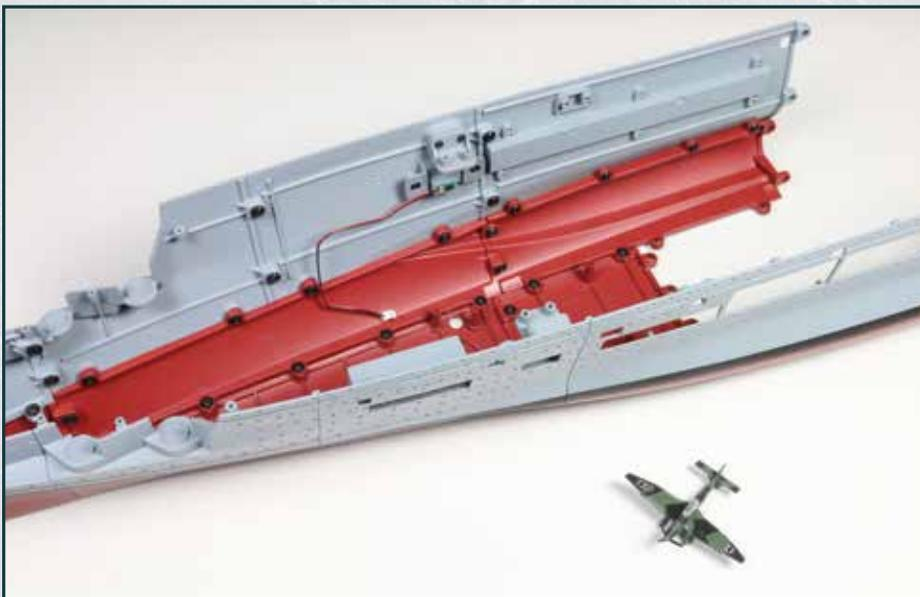
Das fünfte Bordflugzeug hat seinen Propeller, seine Fahrwerksbeine und Bomben erhalten. Zwei Winkel wurden an der Rumpfstruktur angebracht.
