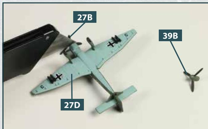
**4** Sollte der Propeller des Bordflugzeugs **27D** beschädigt sein, trennen Sie den Propeller **27B** mithilfe eines Cutters, den Sie an der Flugzeugunterseite ansetzen, heraus. Ersetzen Sie ihn anschließend durch den zweiten Propeller **39B**.
