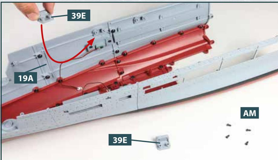
**1** Legen Sie die Rumpfstruktur auf Ihre Arbeitsplatte. Daneben positionieren Sie die beiden Winkel **39E** und vier Schrauben **AM**. Nehmen Sie einen der Winkel und platzieren Sie ihn auf der Aufnahme des rechten oberen Rumpfabschnitts **19A**, wie es der Pfeil andeutet.
