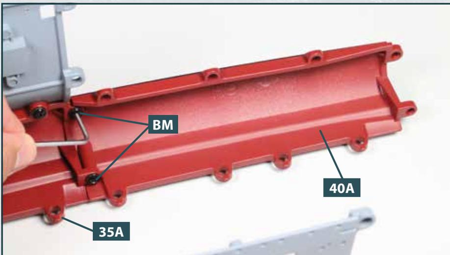
**2** Befestigen Sie den Rumpfabschnitt **40A** mit zwei Sechskantschrauben **BM** am Rumpfabschnitt **35A**. Verwenden Sie zum Eindrehen der Sechskantschrauben den Innensechskant.
