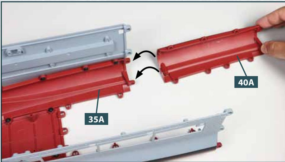
**1** Legen Sie die Rumpfstruktur auf Ihre Arbeitsplatte. Nehmen Sie den rechten unteren Rumpfabschnitt **40A** und führen Sie die Zapfen an dessen Vorderseite zu den beiden Aufnahmen am Rumpfabschnitt **35A**, wie es die Pfeile andeuten.
