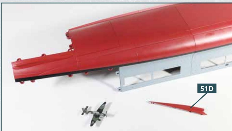
Das siebte Bordflugzeug hat seinen Propeller, seine Fahrwerksbeine und Bomben erhalten. Die linke vordere Wellenhose ist am Rumpf montiert. Die rechte vordere Wellenhose **51D** wird erst mit der 53. Bauanleitung am Rumpf angebracht. Bewahren Sie sie so lange gut auf.
