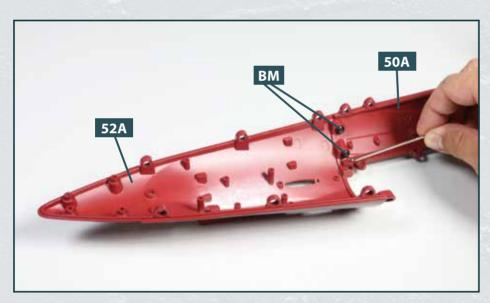
2 Befestigen Sie den Heckabschnitt **52A** mit zwei Sechskantschrauben **BM** am Rumpfabschnitt **50A**. Verwenden Sie zum Eindrehen der Schrauben einen Innensechskantschlüssel.
