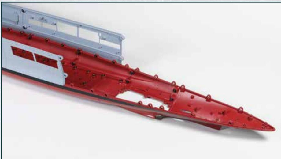
Der letzte rechte untere Rumpfabschnitt, der zuvor mit einer Wellenhose ausgestattet wurde, ist in die Rumpfstruktur eingefügt und an dieser befestigt.
