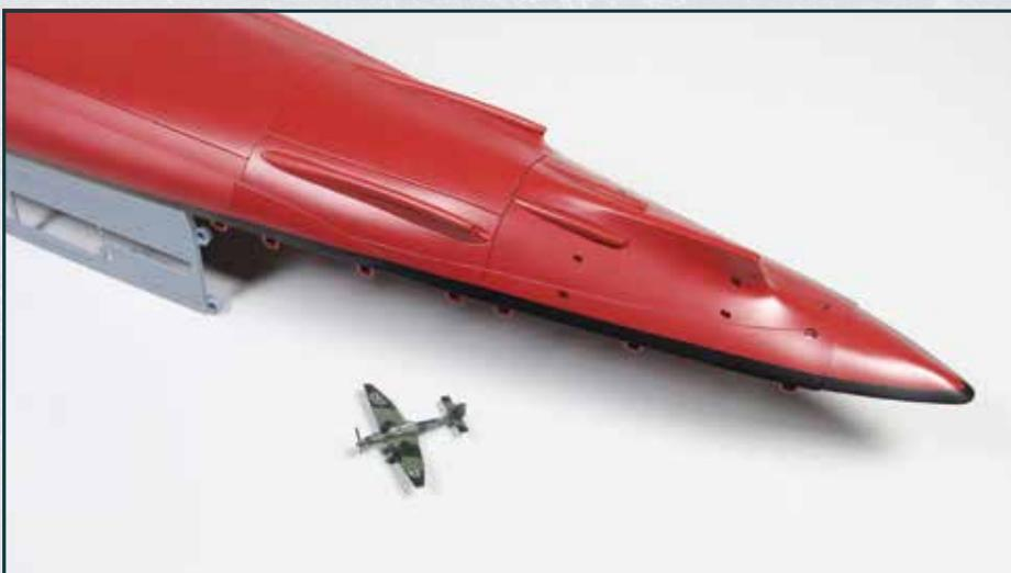
Das achte Bordflugzeug hat seinen Propeller, seine Fahrwerksbeine und Bomben erhalten. Die beiden achteren Wellenhosen sind am Rumpf befestigt.
