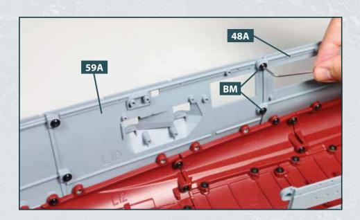
Die beiden Zapfen an der Vorderseite des Rumpfabschnitts **59A** werden mit je einer Schraube **BM** am Rumpfabschnitt **48A** fixiert.
