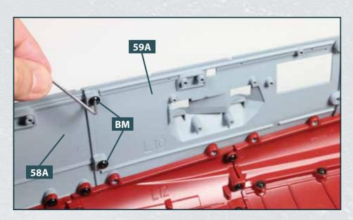
Befestigen Sie die beiden Zapfen an der Hinterseite des Rumpfabschnitts **59A** mit jeweils einer Schraube **BM** am Rumpfabschnitt **58A**.
