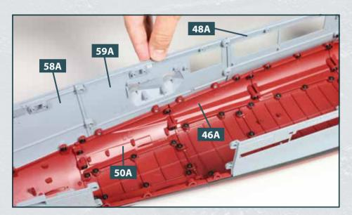
Nehmen Sie den linken oberen Rumpfabschnitt **59A** und fügen Sie seine Zapfen in die Aufnahmen der benachbarten Rumpfteile **46A**, **48A**, **50A** und **58A** ein.
