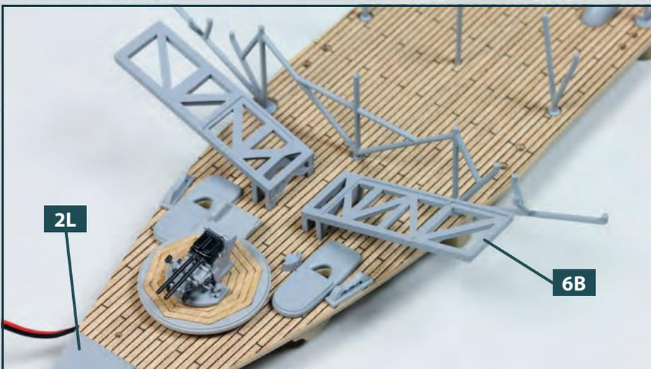
**2** Drücken Sie die Füße des linken Schrägaufzugs **6B** in die Bohrungen des Unterdeckabschnitts **2L** hinein, wie abgebildet.
