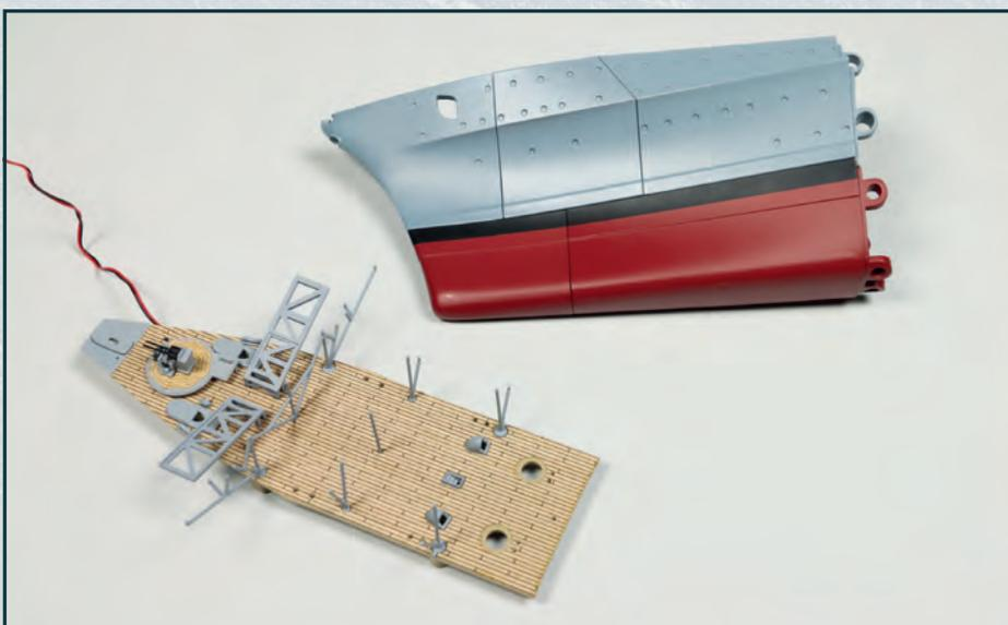
Am Unterdecksabschnitt wurde der zweite Schrägaufzug befestigt. Die Rumpfstruktur ist um einen Abschnitt auf der Backbordseite gewachsen.
